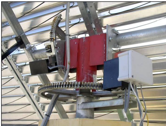
Figura 6.26 - Inseguitore alt-azimutale con vite senza fine e cremagliera.
