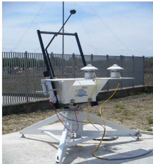
Figura 2.10 – Piranometro con sfera d'occultazione.
