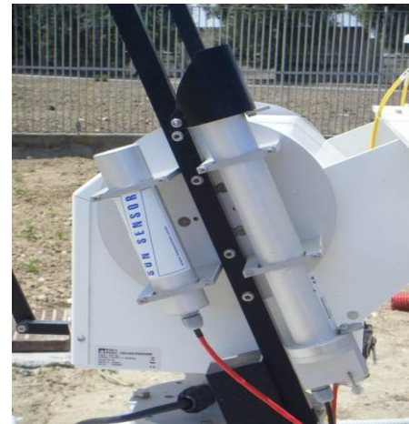
Figura 2.3 – Pireliometro: schema e posizionamento sul sun-tracker.
