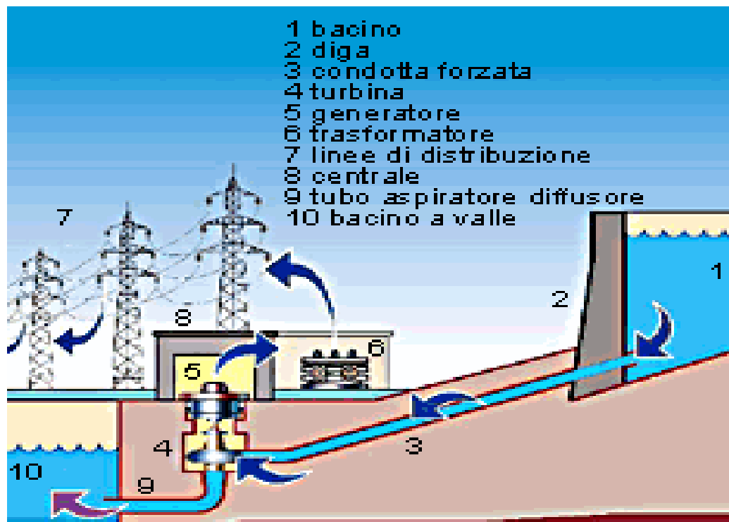
Figura 1.3 – Centrale idroelettrica a doppio bacino.
