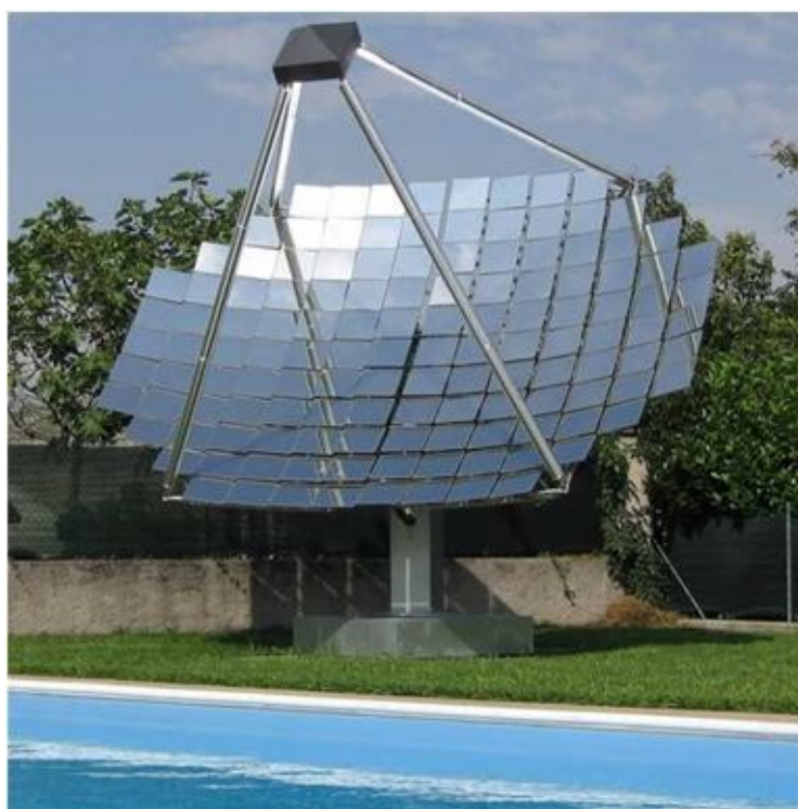
Figura 2.1. Il concentratore Solex A10 montato a terra per riscaldamento di una piscina scoperta.
