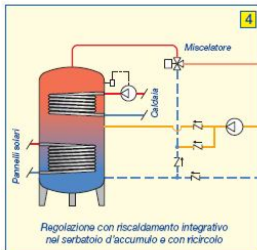
Figura 4.3. Schema regolazione acqua calda sanitaria.
