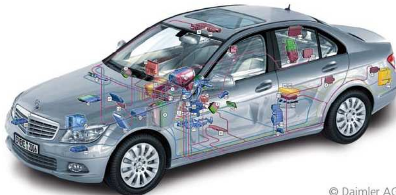
Figura A.1 – In un veicolo stradale moderno possono essere presenti fino a 70 centraline di controllo elettronico collegate tra loro. La complessità di questa rete, unita con la presenza di un incredibile numero di varianti nella configurazione del veicolo, ha portato alla realizzazione del Controlled Area Network.
