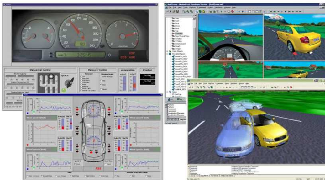
Figura 4.13 – Interfaccia utente in ControlDesk (a sinistra) per l’interazione real time con il sistema HiL e in MotionDesk (a destra) per la visualizzazione 3D delle manovre effettuate.
