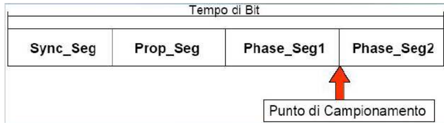
Figura A.5 – Suddivisione del Nominal Bit Time (NBT)
