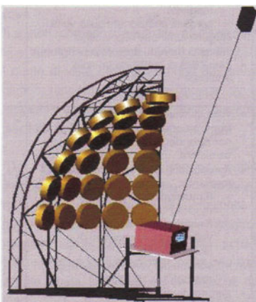
Schema di cielo artificiale a porzione di volta con il simulatore di cielo e di sole.
