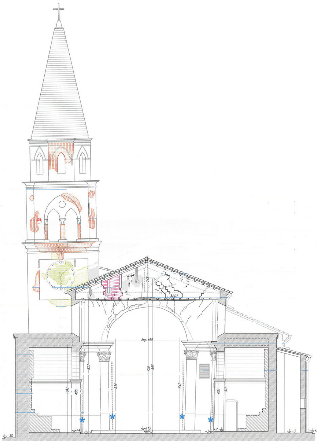
Fig. 349. Rilievo della sezione trasversale con indicazioni del degrado. Studio Crotti Castagna 2003.
