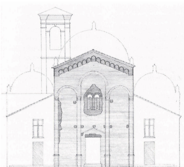
Fig. 205. Il prospetto frontale oggi. Si evidenziano gli interventi di integrazione. Si noti l'impostazione barocca tratteggiata. Da Bussolotti C. 2005, p. 35.
