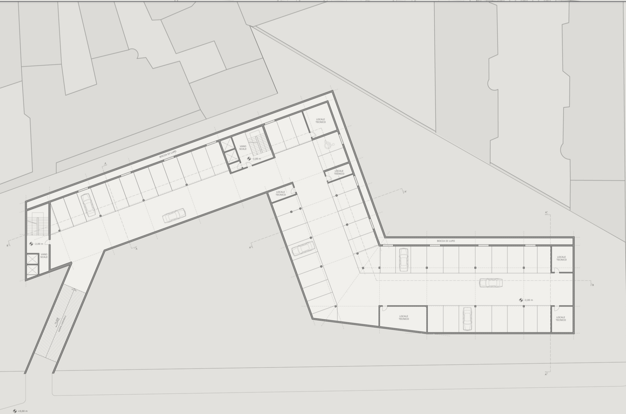
PIANTA PIANO INTERRATO quota -2,00m
