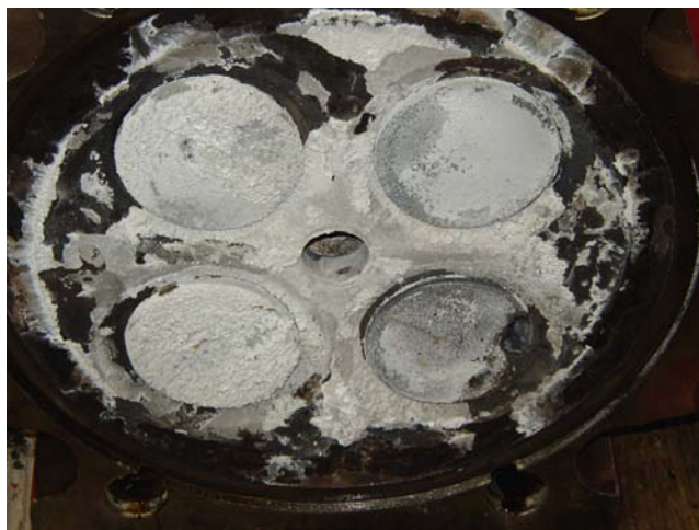
Fig. 3.1 Depositi silicei in camera di combustione di un MCI
