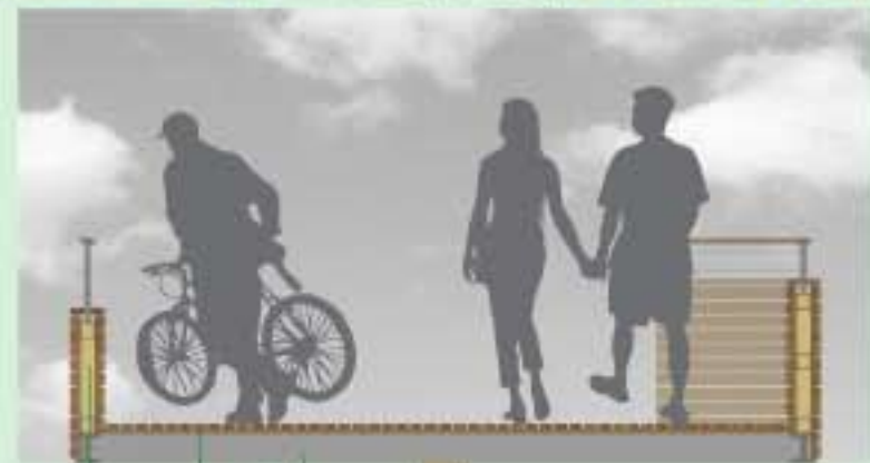
STRUTTURA PORTANTE PONTE IN ACCIAIO DOGHE IN LEGNO STRUTTURA PORTANTE PARAPETTO IN ACCIAIO
