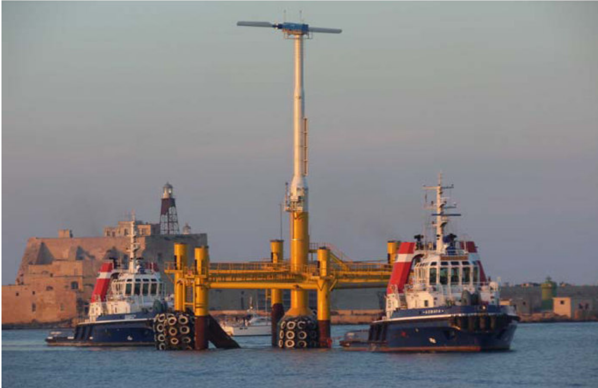
(fig.16, prototipo Blue H portato verso il largo da un rimorchiatore)
