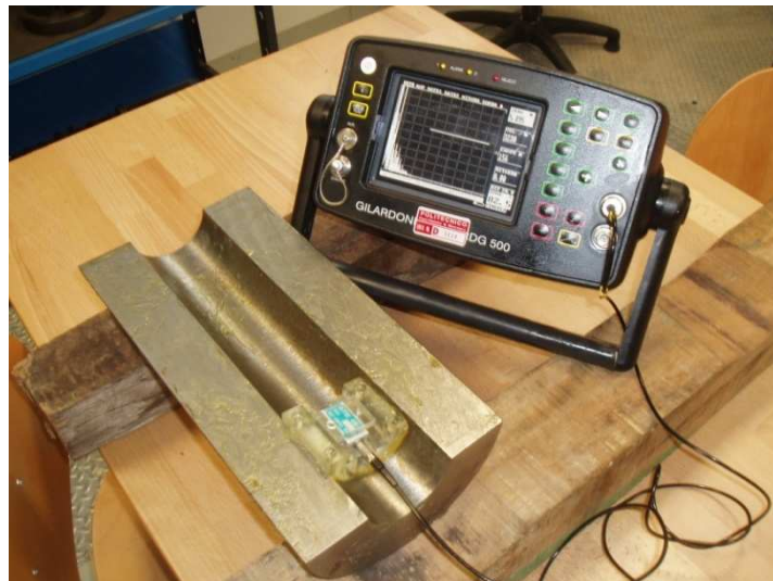
Fig. 2.21 controllo difetti in primo percorso
