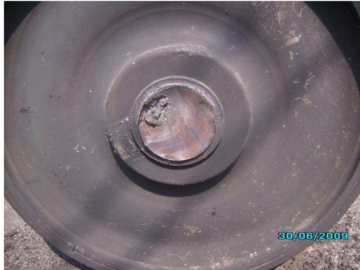
Fig. 1.2 sezione di rottura dell'assile, causa del disastro di Viareggio
