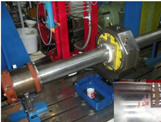
Fig.3.3 calettamento cuscinetto centrale
