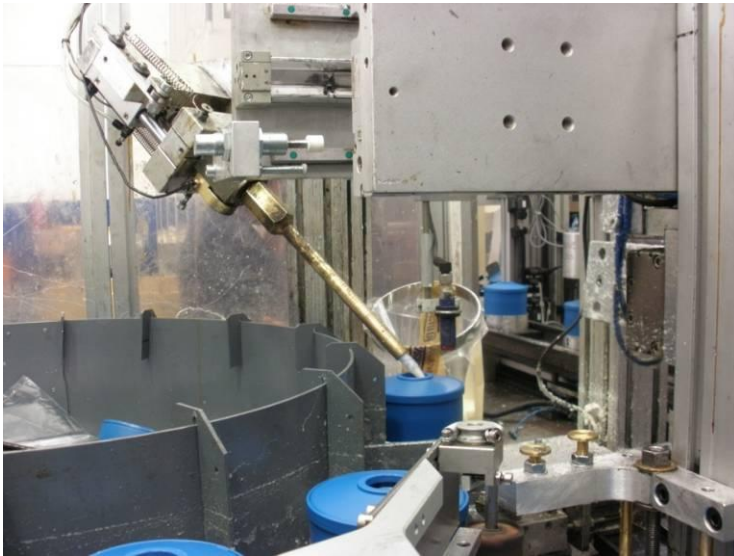
Figura 4.6: pistola di dosatura della colla
