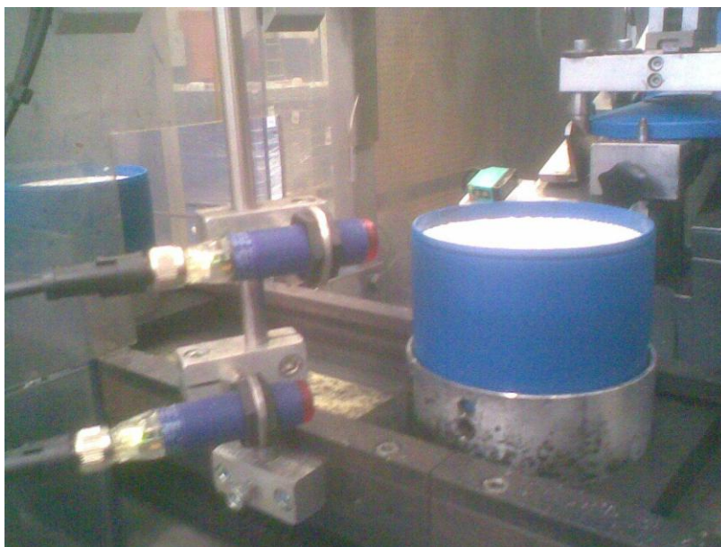
Figura 5. 6: sensori della stazione di carico coperchio dopo la modifica
