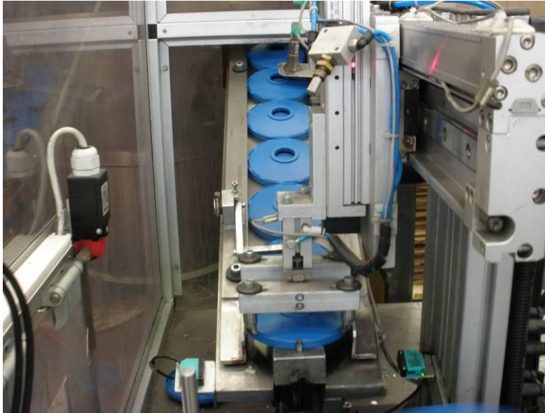
Figura 2.19: pinza di carico coperchio
