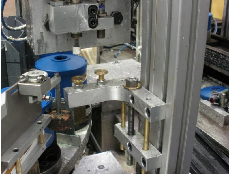
Figura 5. 12: struttura di regolazione del finecorsa della pinza di scarico
