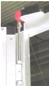
Figura 2.5: dettaglio dell'interruttore di sicurezza
