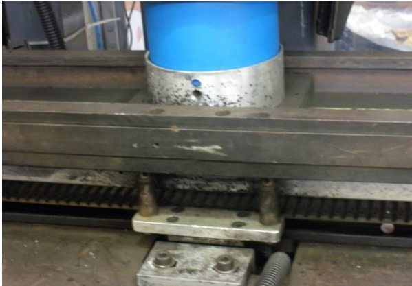
Figura 2.7: blocco di fissaggio del pallet
