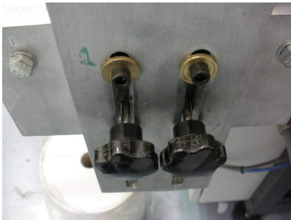
Figura 5. 7: manopole di regolazione dell'altezza del cadenzatore
