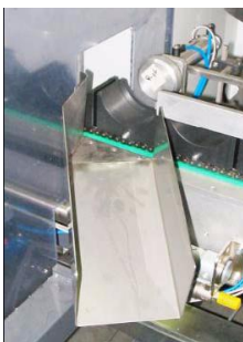
Figura 2.29: stazione scarico scarti
