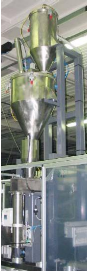
Figura 2.13: tramogge della stazione di carico polveri
