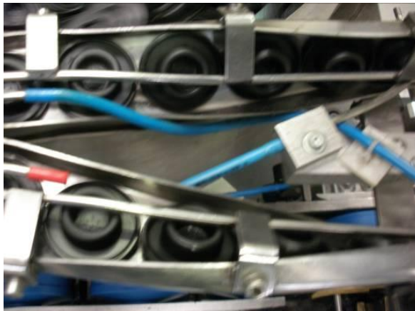
Figura 5. 21: dettaglio della guida dei tappi
