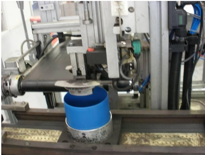
Figura 2.6: pinza di carico corpi
