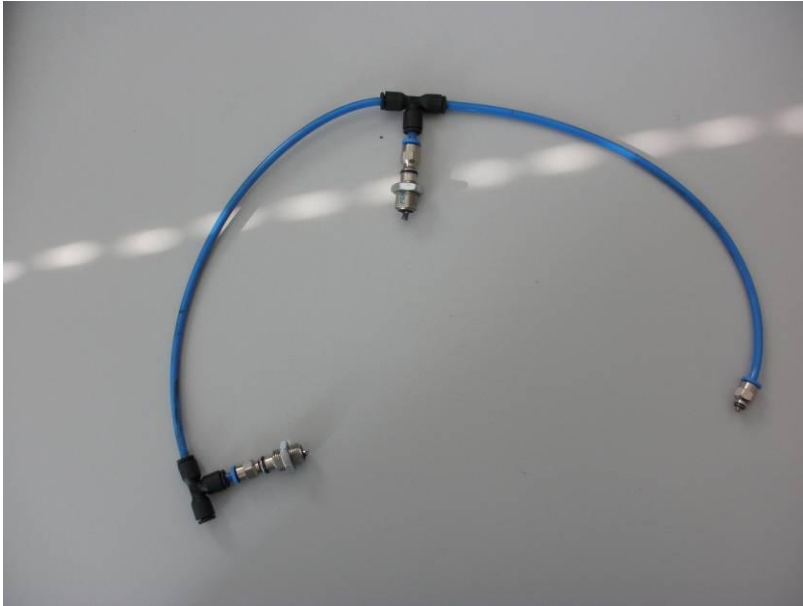
Figura 5. 3: pistoncini di distacco del diaframma prima della modifica
