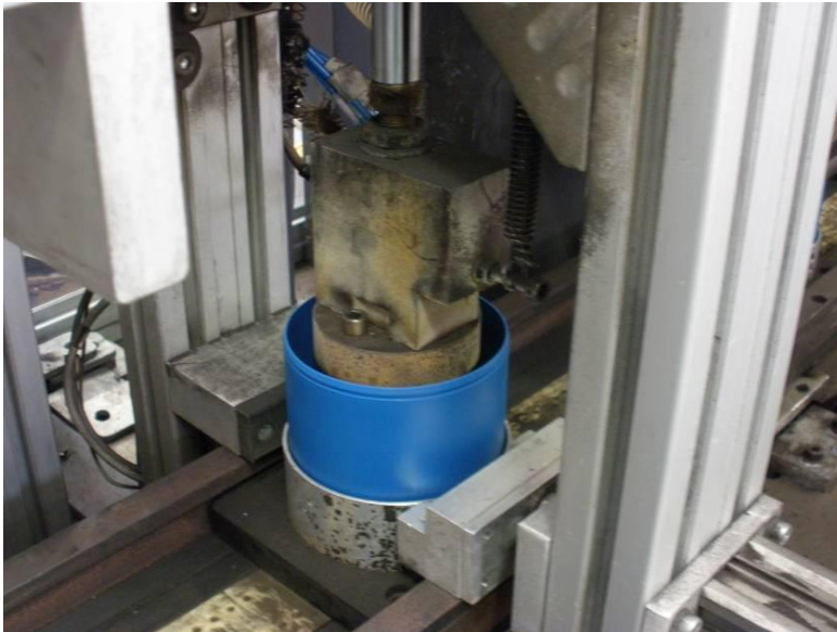
Figura 2.11: operazione di saldatura della texilina
