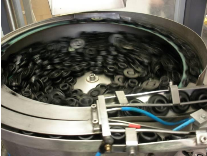
Figura 2.30: vibratore di carico tappi
