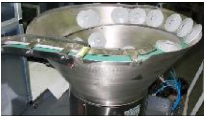
Figura 2.18: vibratore di carico coperchi
