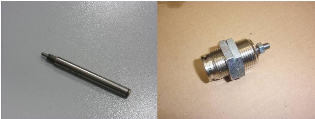
Figura 5. 2: i pistoncini di azionamento del piattello prima e dopo la modifica
