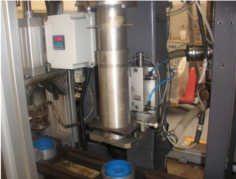
Figura 4. 3: tubo convogliatore della stazione carico polveri
