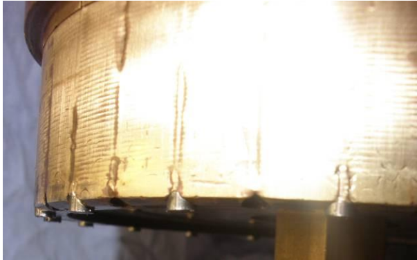
Figura 4.9: cilindri di deformazione del diaframma
