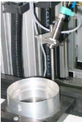
Figura 2.8: sensore di presenza involucro
