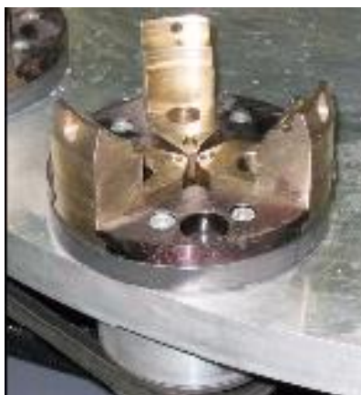
Figura 2.22: pinza di bloccaggio del filtro
