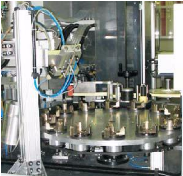
Figura 2.21: tavola rotante della stazione di dosatura colla
