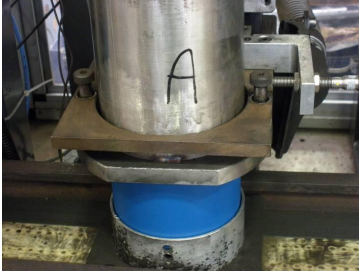
Figura 2.14: operazione di carico polveri
