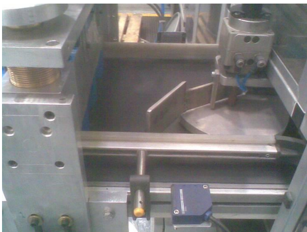
Figura 5. 9: sensore presenza involucro sul nastro di alimentazione
