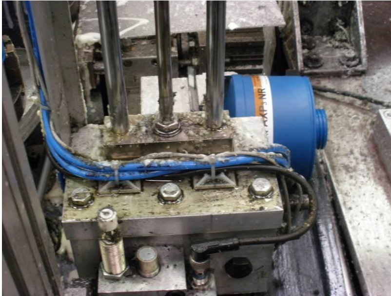
Figura 2.26: pinza di scarico da tavola rotante
