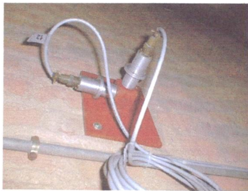
Figura 92 – Un servoaccelerometro applicato sul Torrazzo
