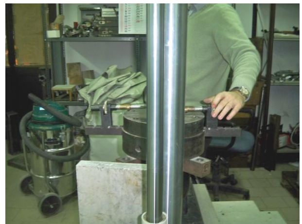
Figure 147 e 148 – Punte estendibili utilizzate per verificare la centralità del blocco di calcestruzzo
