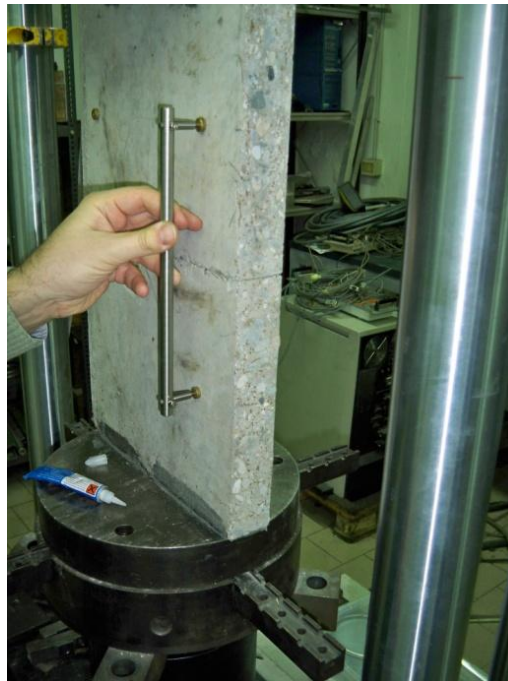
Figura 168 – Posizionamento delle seconde biffe della coppia mediante la dima di riferimento in invar (base 250 mm)
