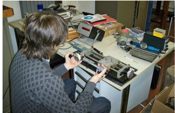
Figura 177 e 178 – A sinistra l’operatore A mentre esegue una lettura sul deformometro Huggenberger EDU. A destra l’operatore B mentre esegue una lettura sul deformometro Huggenberger EDU II
