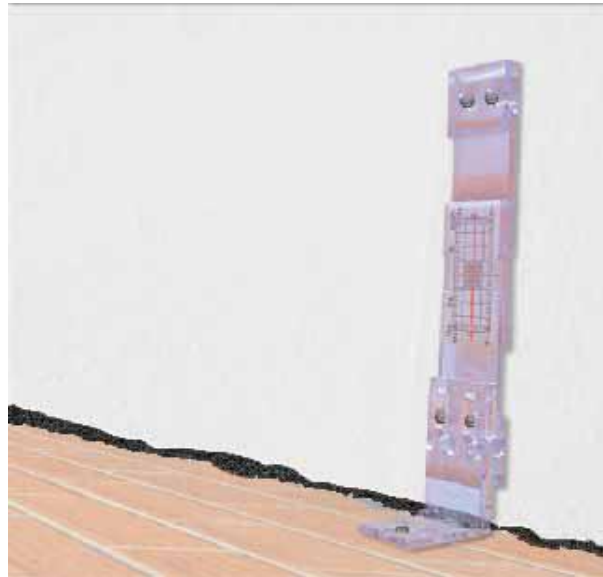
Figura 54 – Un esempio di fessurimetro per pavimenti
