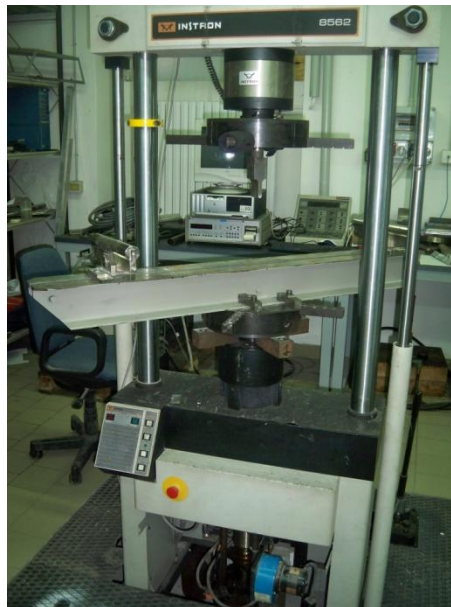
Figura 140 – Pressa elettromeccanica Instron 8562
