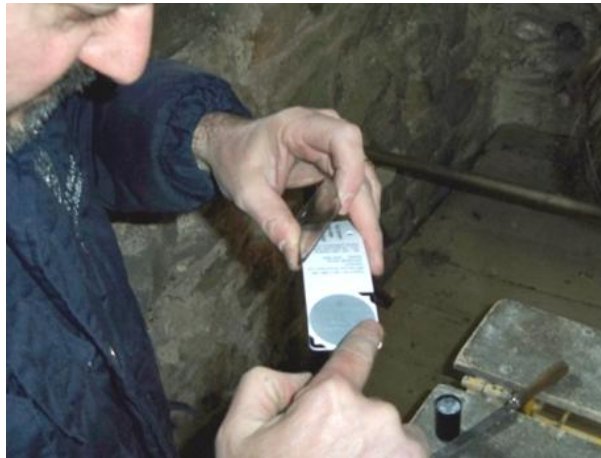
Figura 235 – L'applicazione della vaselina sui due componenti del fessurimetro moiré
