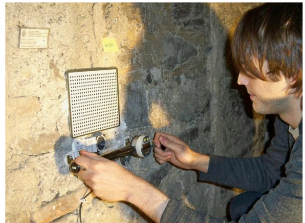
Figure 256 e 257 – I due deformometri a base 250 mm. A sinistra il modello Huggenberger EDU; a destra il modello Huggenberger EDU II
