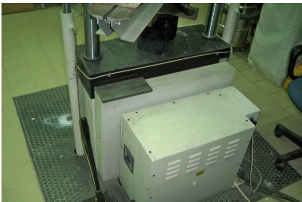
Figure 143 e 144 – Particolari della pressa elettromeccanica servocontrollata Instron 8562
