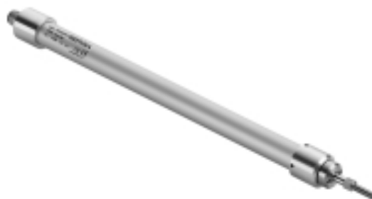
Figura 208 - Un trasduttore potenziometrico (modello GEFRAN PZ67-S ) come quelli installati sulla torre campanaria di S. Vittore ad Arcisate
