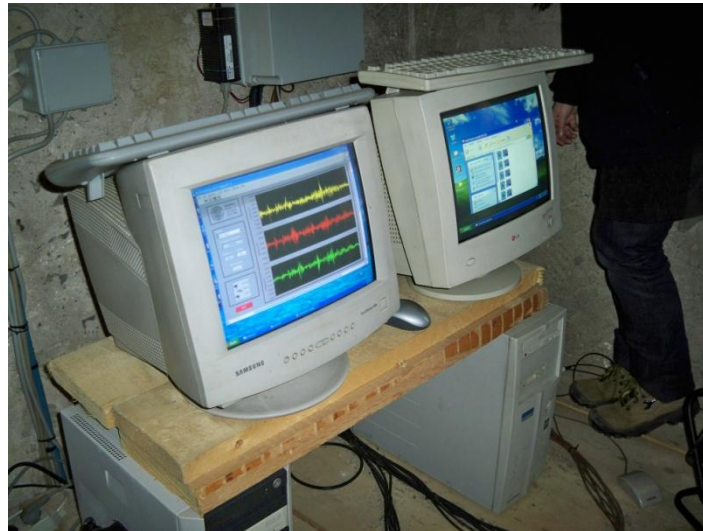
Figura 211 – I due computer predisposti all’acquisizione dei valori del monitoraggio dinamico (a sinistra) e statico (a destra)
