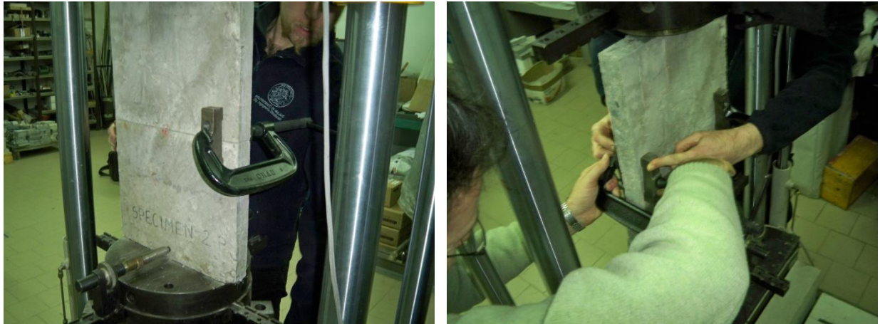
Figure 151 e 152 – Fissaggio dei due blocchi di calcestruzzo con dei morsetti per stabilizzare la fase di incollaggio
