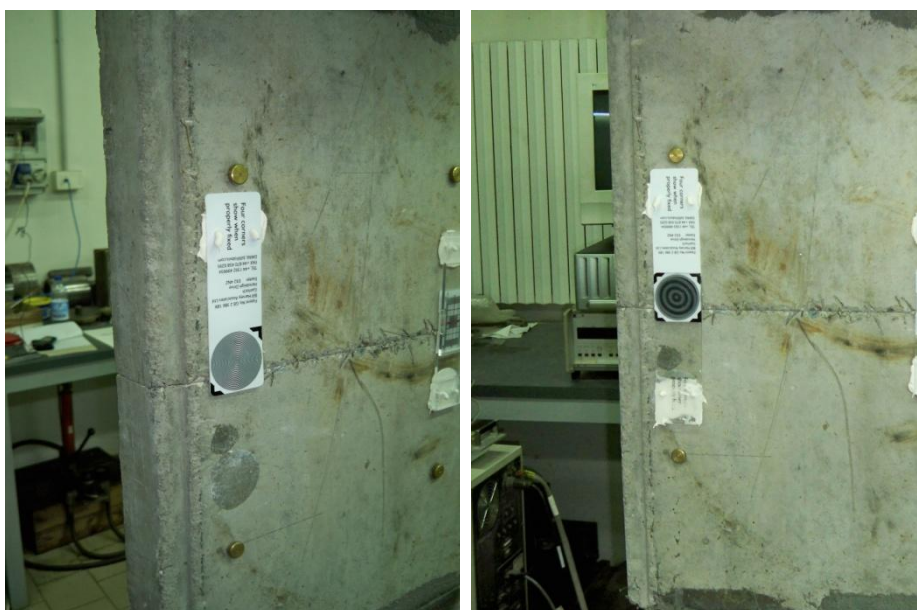
Figure 186 e 187 – Un fessurimetro moiré durante l'incollaggio delle due diverse componenti
