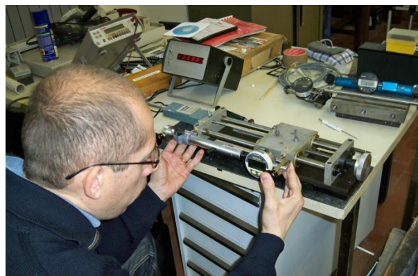
Figura 179 – L’operatore C mentre esegue una lettura sul deformometro Huggenberger EDU II
