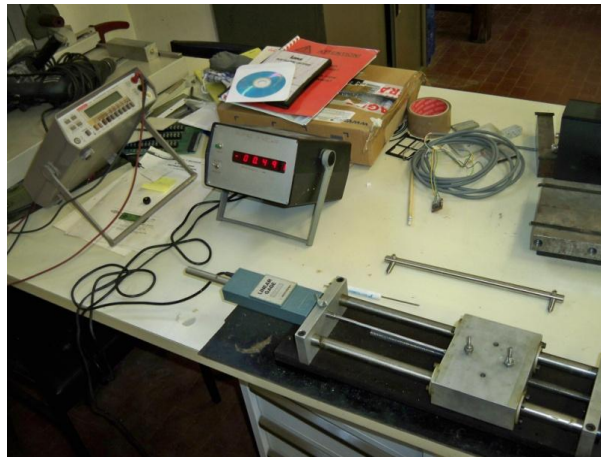
Figura 174 – Il banco di taratura (in basso a destra) e la sua interfaccia dove leggere gli spostamenti
