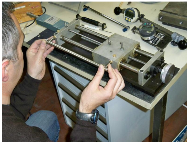
Figura 175 – Posizionamento delle due basette su piano verticale attraverso una dima in acciaio invar (base 250 mm)
