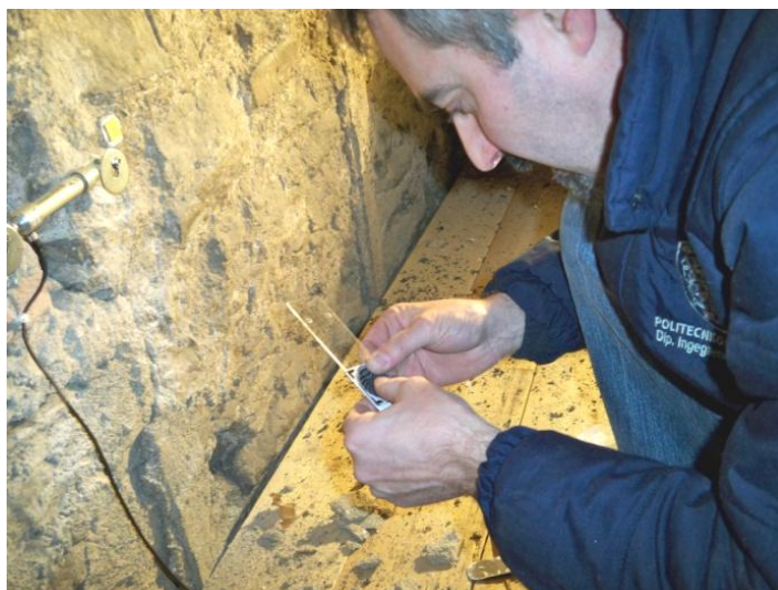
Figura 222 – Fase di adesione dei due componenti del fessurimetro moiré tramite vaselina
