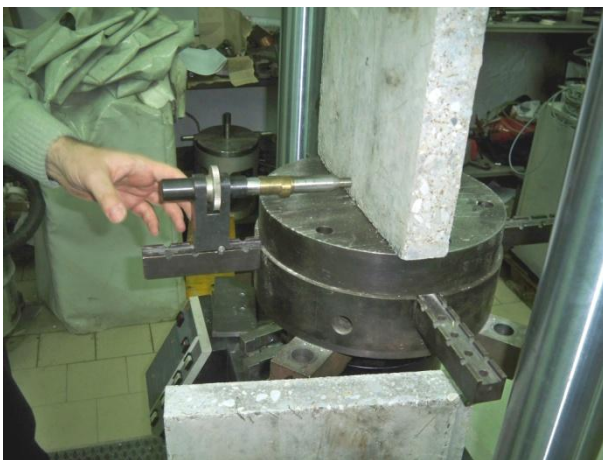
Figure 147 e 148 – Punte estendibili utilizzate per verificare la centralità del blocco di calcestruzzo
