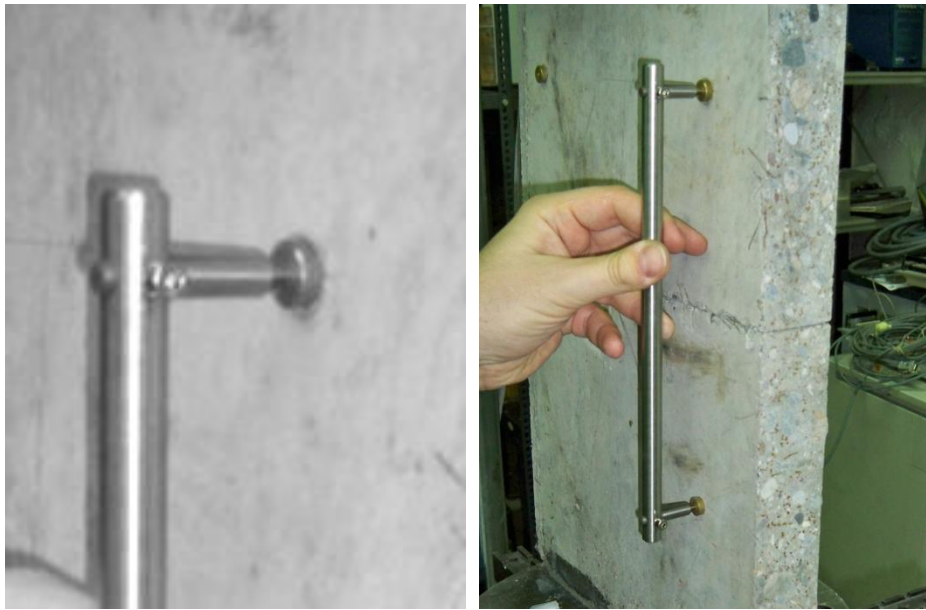
Figure 62 e 63 – La dima di posizionamento e le basette nella fase di incollaggio
