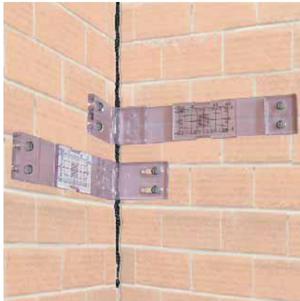
Figura 53 – Esempio di fessurimetri angolari
