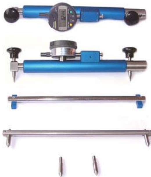
Figura 60 – Il deformometro meccanico Huggenberger serie EDU (base 250 mm) ed i suoi accessori
