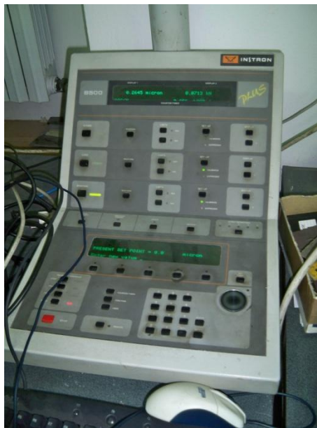
Figura 170 – L'interfaccia digitale della pressa elettromeccanica servocontrollata Instron 8562
