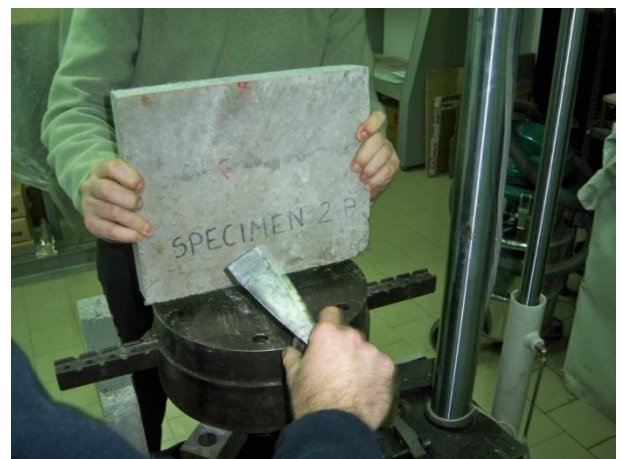
Figure 149 e 150 – Incollaggio del primo blocco di calcestruzzo sul piatto inferiore della Instron 8562
