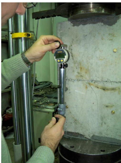
Figura 39 – Esempio di lettura manuale eseguita con uno strumento removibile (deformometro meccanico digitale)
