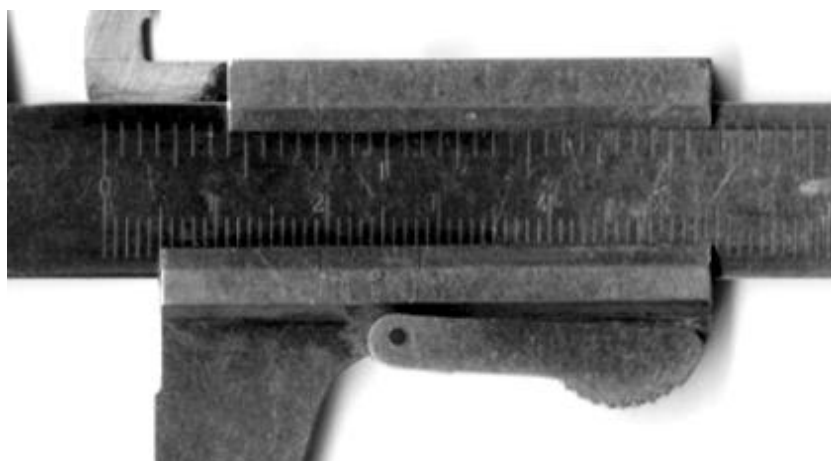
Figura 98 – Particolare del nonio di un calibro
