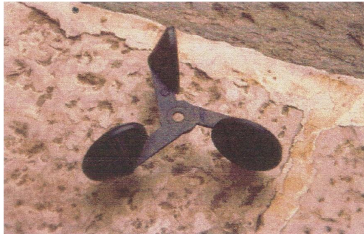
Figura 90 – Un anemometro a coppe
