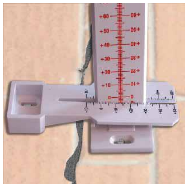
Figura 55 – Un esempio di fessurimetro per dislivelli
