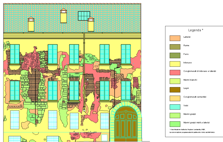
Figura 30 – Esempio di elaborato di sintesi di un rilievo materico
