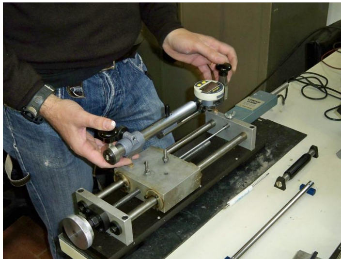
Figura 176 – Prime letture sul deformometro Huggenberger EDU II
