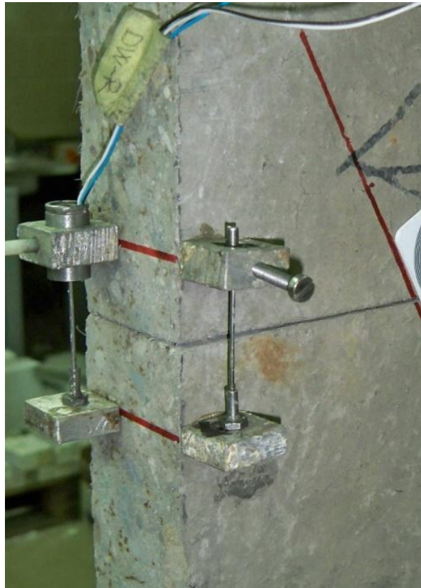
Figura 160 – I trasduttori induttivi fissati sui blocchi di calcestruzzo
