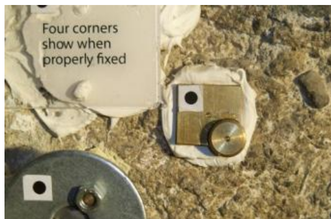
Figura 252 – Particolare dell’incollaggio della nuova basetta in sovrapposizione a quella precedentemente incollata alla muratura
