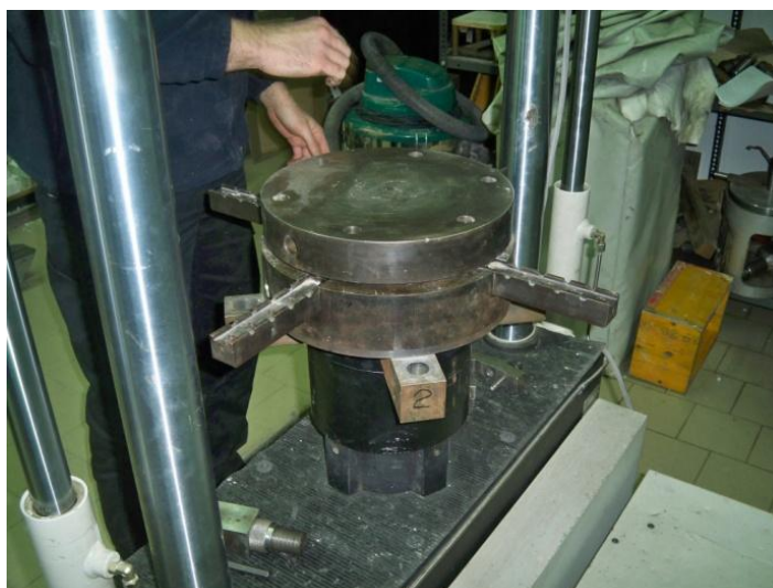
Figura 146 – Il piatto in acciaio avvitato sopra il piatto fisso della pressa Instron 8562
