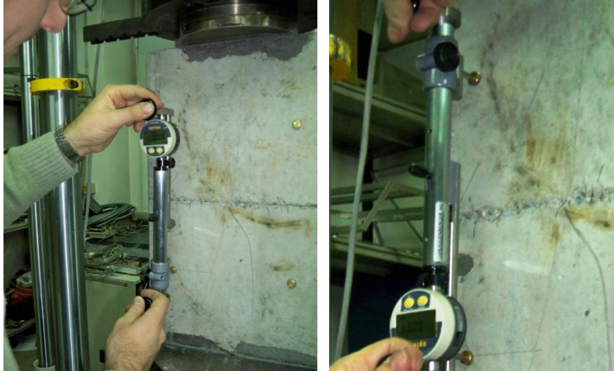
Figure 171 e 172 – Esecuzione delle letture dritta e inversa con il deformometro meccanico digitale (letture B)
