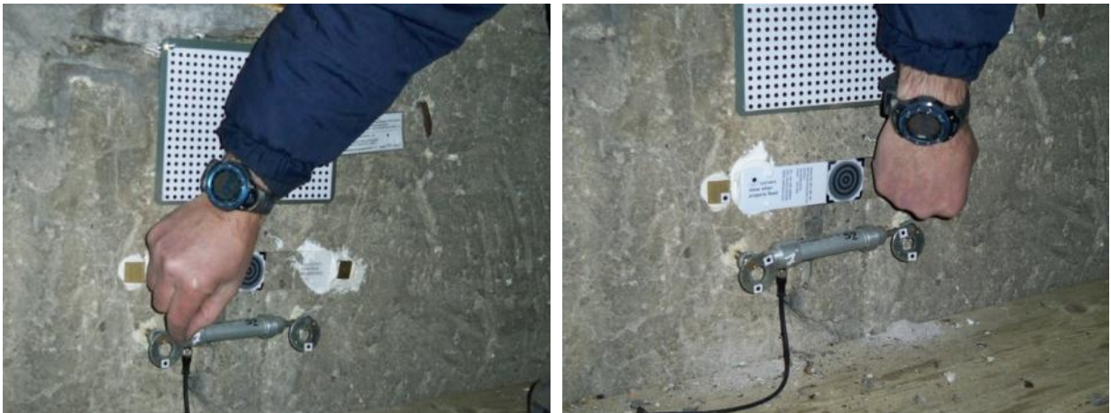
Figure 243 e 244 – Fase di incollaggio delle mire per il metodo dell'analisi delle immagini
