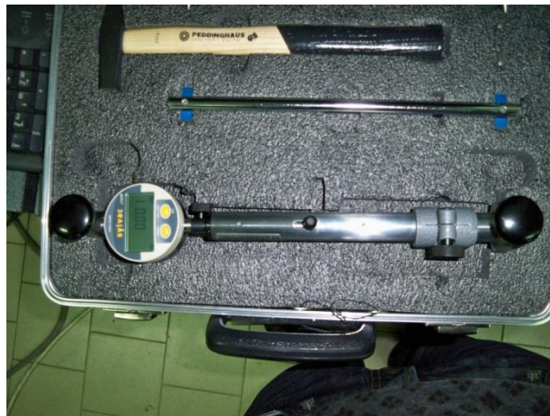
Figure 161 – Il deformometro meccanico Huggenberger EDU II e gli strumenti in dotazione nella valigetta
