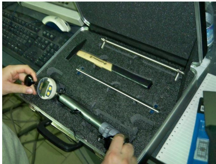
Figura 65 – Tutti gli strumenti presenti nella valigetta di un deformometro Huggenberger serie EDU II (base 250 mm)
