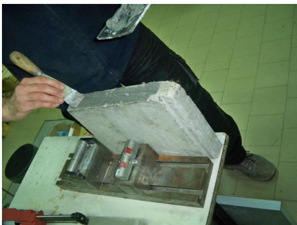
Figure 149 e 150 – Incollaggio del primo blocco di calcestruzzo sul piatto inferiore della Instron 8562
