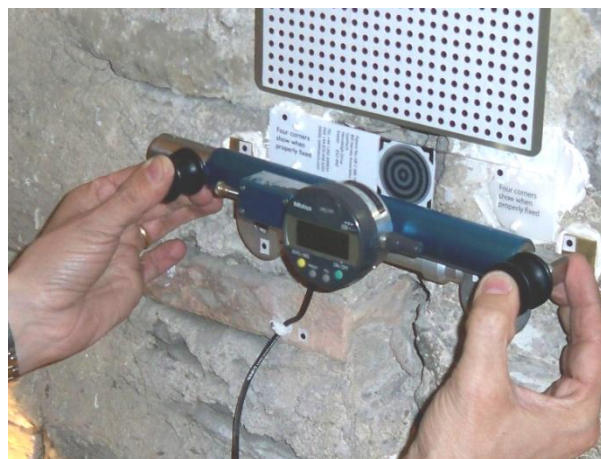
Figura 64 – Una lettura con il deformometro Huggenberger serie EDU (base 250 mm)
