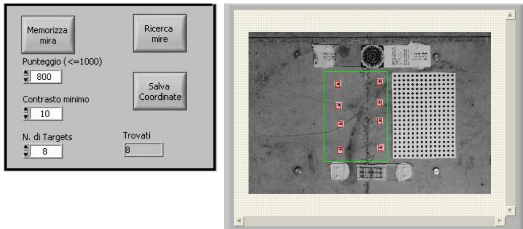
Figure 137 e 138 – Il riquadro dove inserire le specifiche delle mire da ricercare e quello dove disegnare le zone da analizzare dell’immagine
