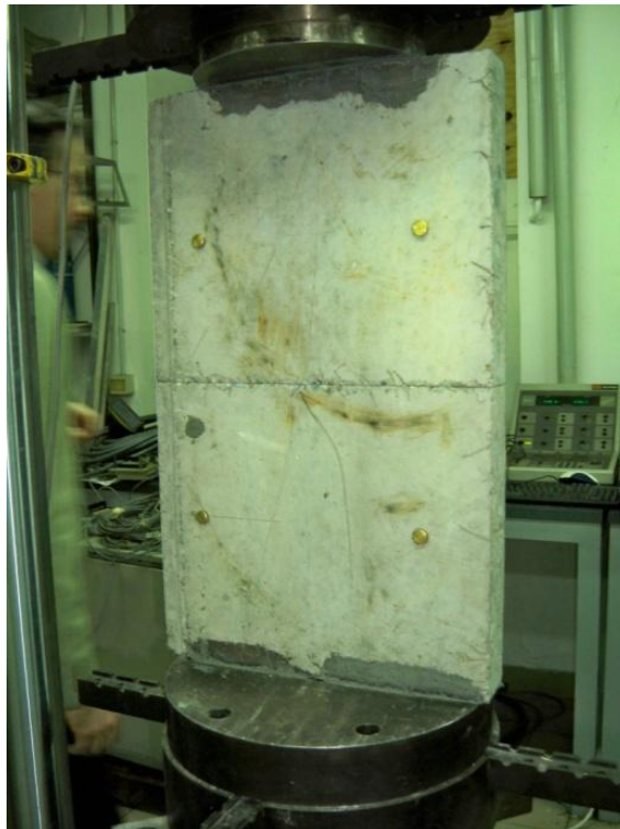
Figura 169 – Le quattro biffe incollate sui due blocchi di calcestruzzo
