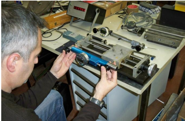
Figura 177 e 178 – A sinistra l’operatore A mentre esegue una lettura sul deformometro Huggenberger EDU. A destra l’operatore B mentre esegue una lettura sul deformometro Huggenberger EDU II
