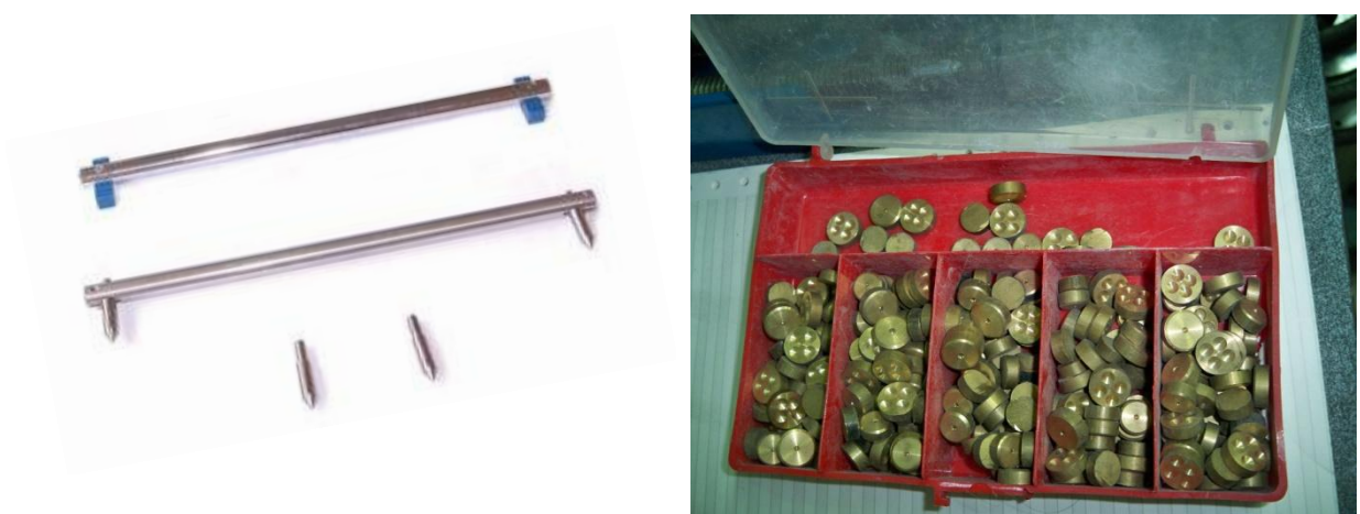
Figure 162 e 163 – Le due dime (di posizionamento e di azzeramento) a sinistra. A destra la scatola che contiene tutte le differenti basette a disposizione
