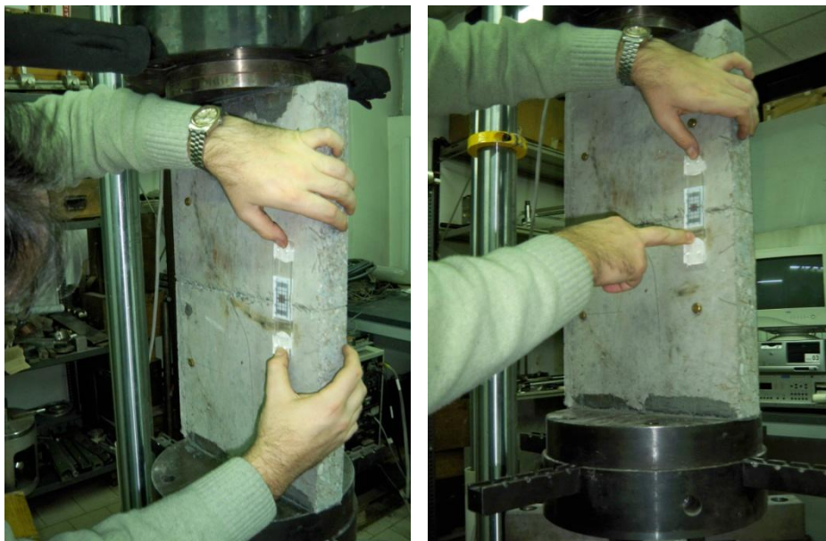
Figura 184 e 185 – Il fissaggio del fessurimetro sui blocchi di calcestruzzo
