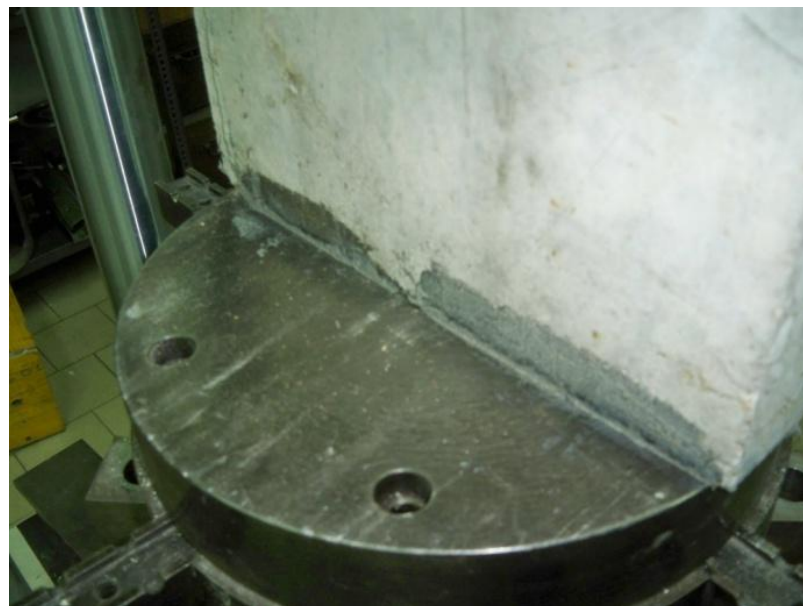
Figura 153 – Fissaggio di incollaggio dei blocchi di calcestruzzo sui piatti in acciaio della Instron 8562
