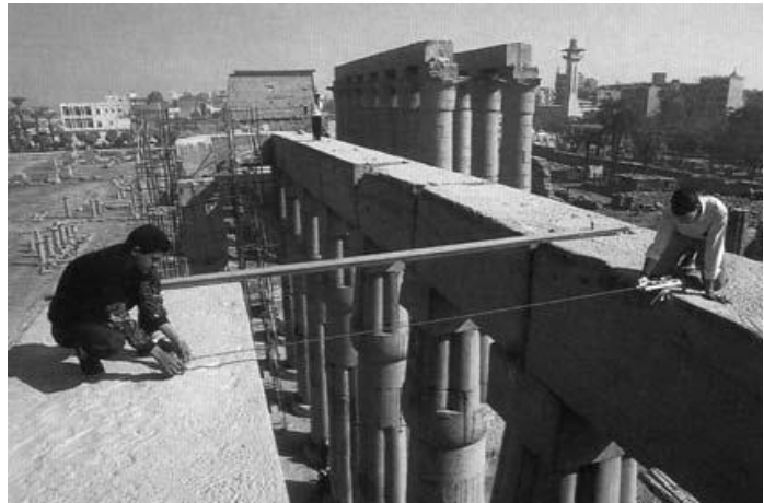
Figure 42 e 43 – Un estensometro meccanico a base lunga ed il suo utilizzo in sito
