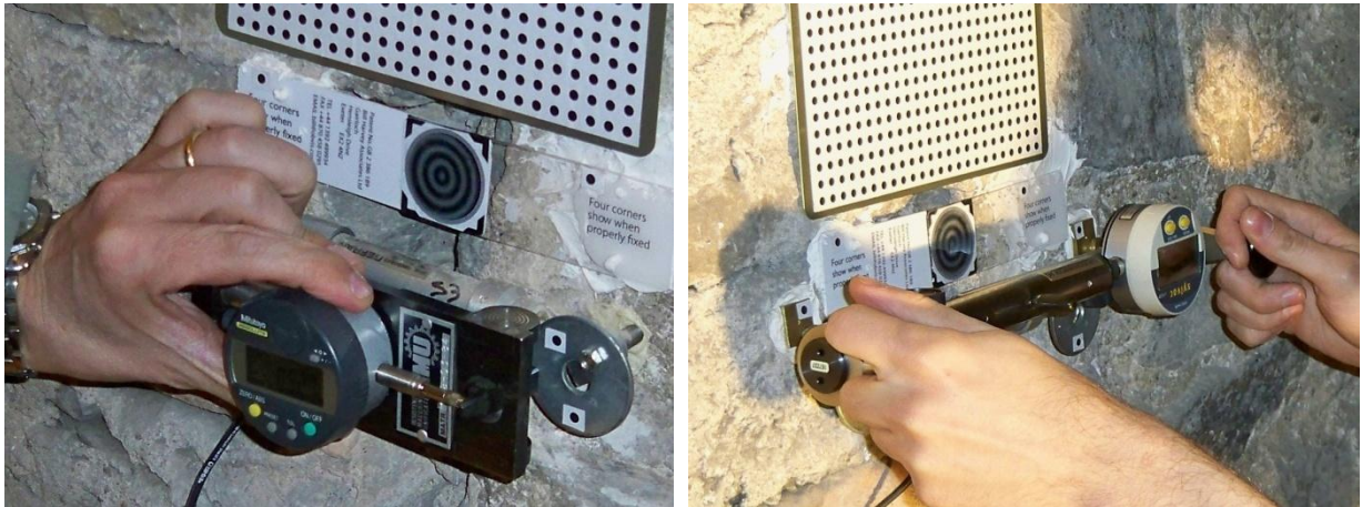
Figure 66 e 67 – A sinistra un deformometro a leverismi. A destra un deformometro a cursore
