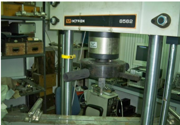
Figure 141 e 142 – Particolari della pressa elettromeccanica servocontrollata Instron 8562
