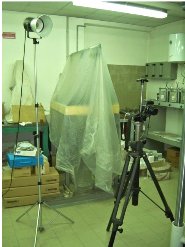
Figura 195 – La macchina fotografica, modello Canon EOS 300D DIGITAL, fissata sul cavalletto ed il riflettore ancora spento
