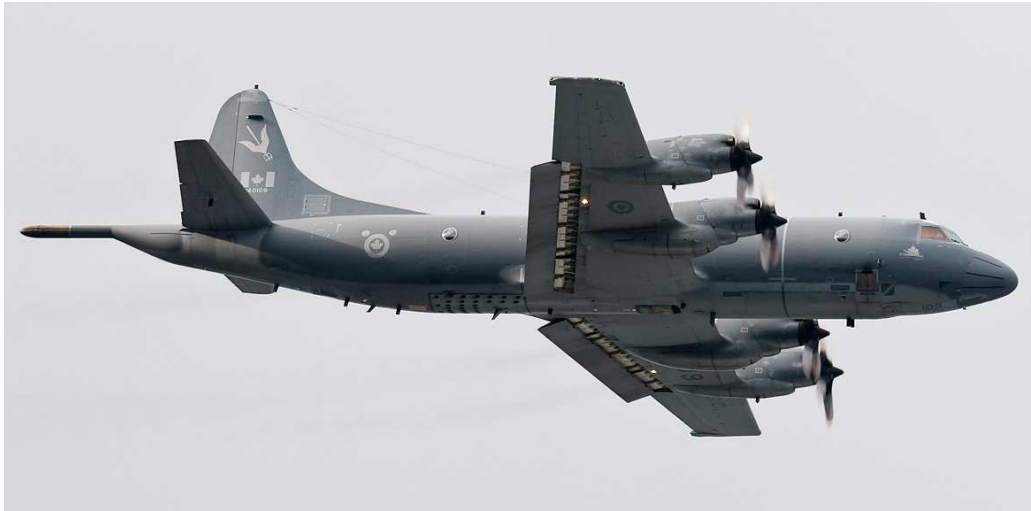
Figura 4.33: CP-140 Aurora, in dotazione alla Canadian Forces Air Command, una delle molteplici versioni del P-3 Orion, prodotto dalla Lockheed Martin Corporation.
