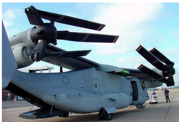
Figura 5.5: Esempio di cappotta per l'albero di trasmissione: il V-22 Osprey in un'area di parcheggio.
