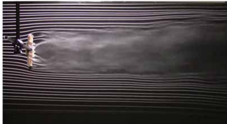
Figura 3.2: Visualizzazioni con linee di fumo per il piano orizzontale del disco biplanare di d = 80\text{mm}
