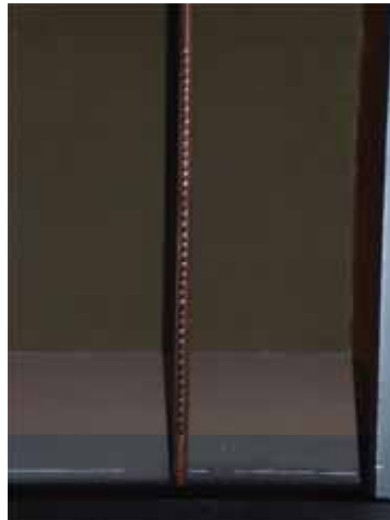
Figura 2.2: Ugelli presenti nello smoke tunnel
