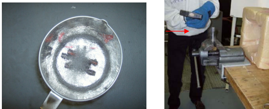
Figura 3.6.3 Rottura fragile del provino tramite azoto liquido
