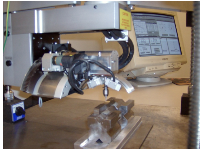
Figura 4.2.4 Misura sforzi residui in superficie: Xstress 3000 AST Stresstech
