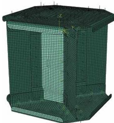
Figura 3.1 Modello incrocio con griglia di calcolo
