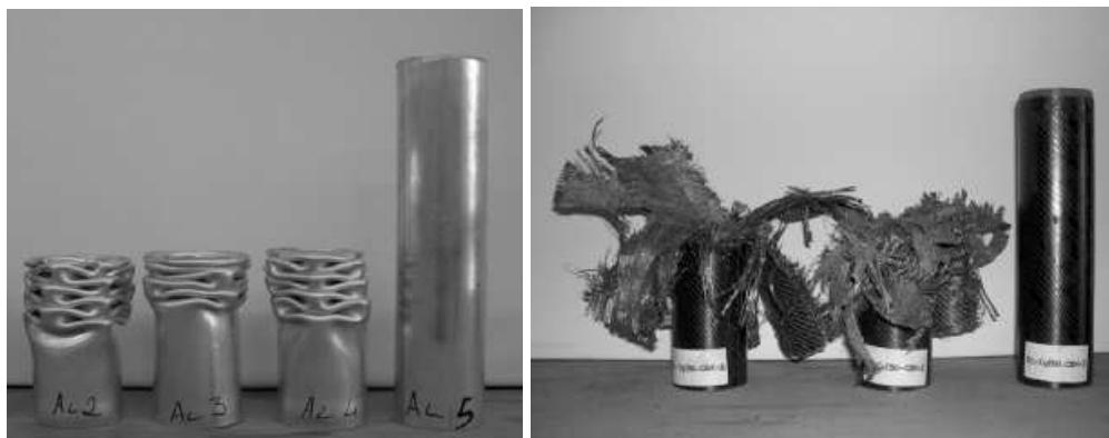
Figura 1.7 Incroci in alluminio e composito prima e dopo l'impatto [6]
