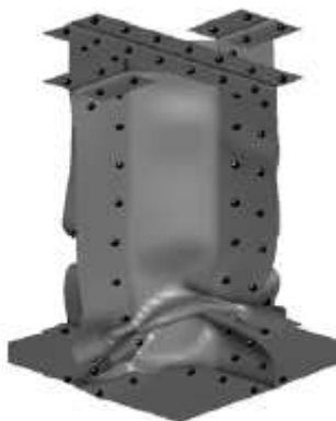
Figura 1.16 Deformata numerica incrocio [12]
