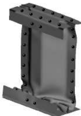
Figura 1.17 Deformata numerica assorbitore intermedio [12]
