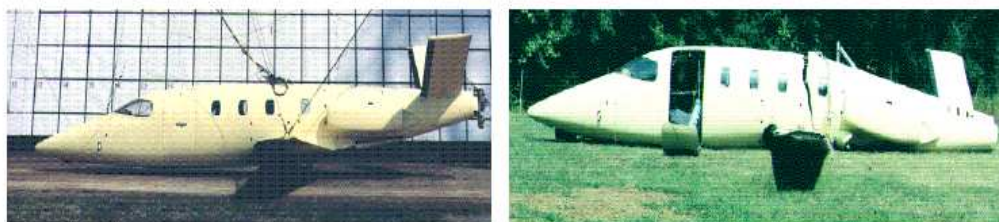
Figura 1.1 Prova di crash su un velivolo in scala reale[3]
