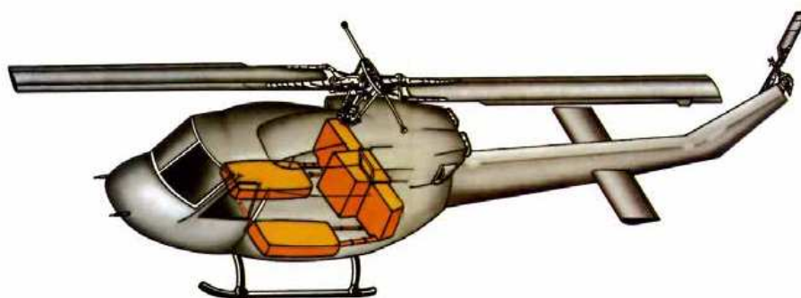
Figura 1.11 Possibile posizionamento serbatoi
