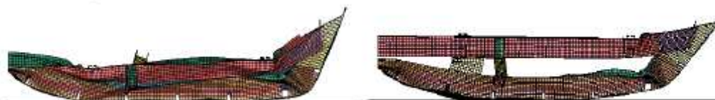
Figura 1.6 Deformazione sottopavimento aereo leggero [5]
