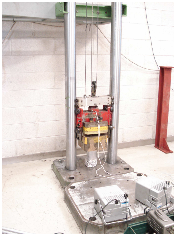
Figura 2.1 Slitta verticale dopo test di funzionamento con il cilindro in alluminio
