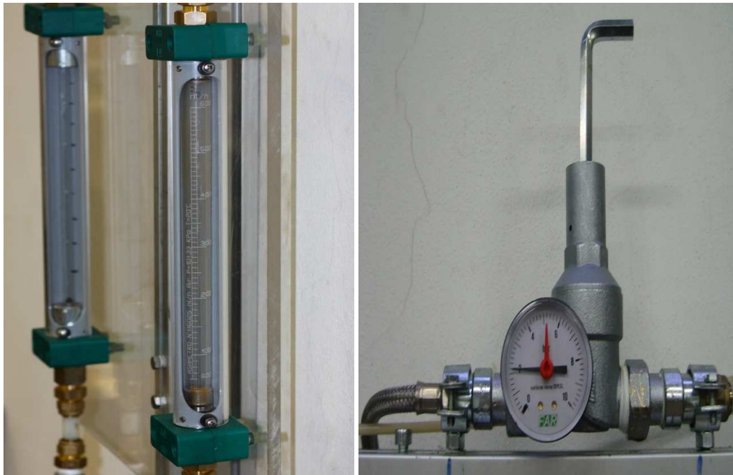
Figura 2.5 - Misuratore di portata di aria e manometro di regolazione pressione in ingresso
