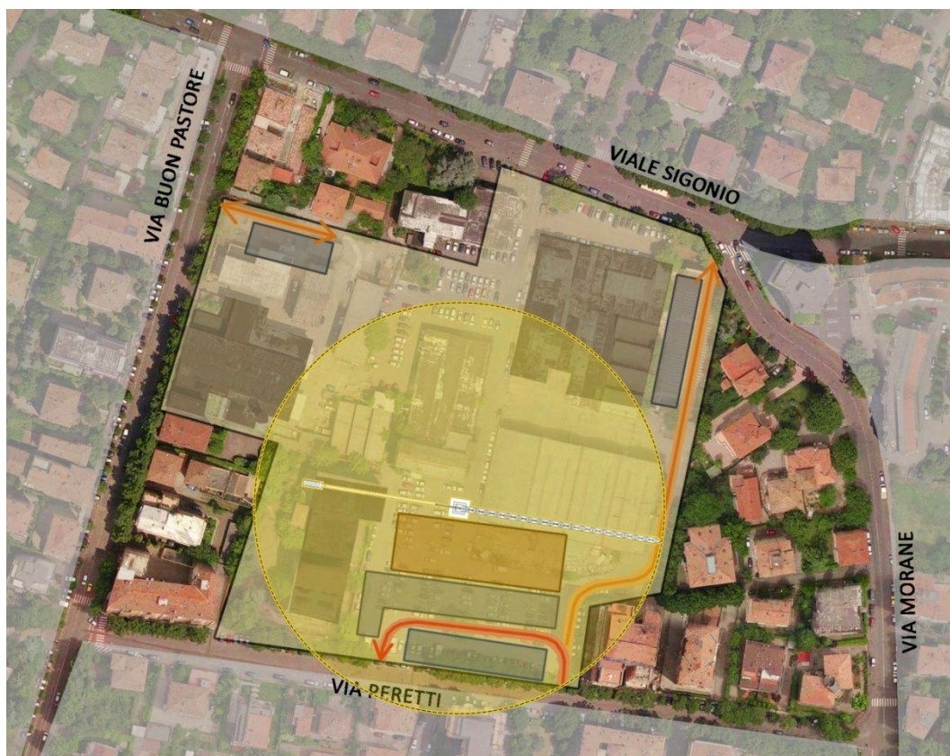
Posizionamento della gru e indicazione del raggio d'azione
