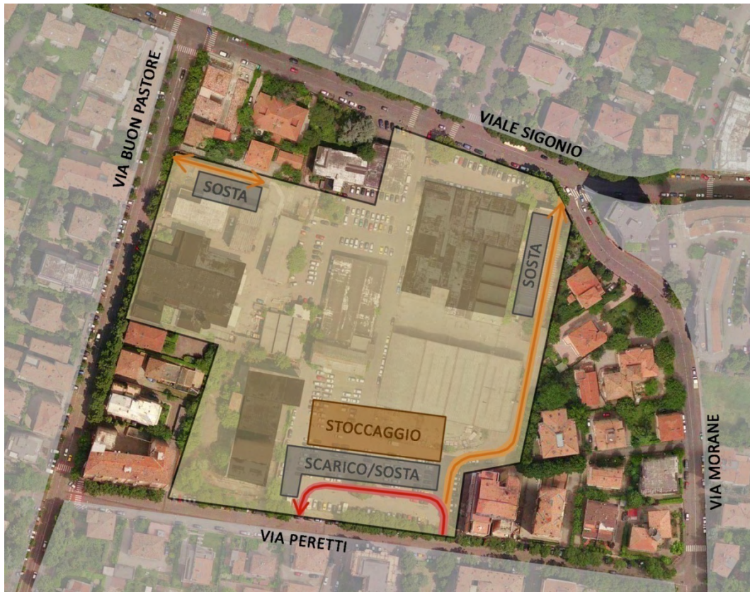
Indicazione delle aree di sosta e scarico dei mezzi e delle aree di stoccaggio dei materiali
