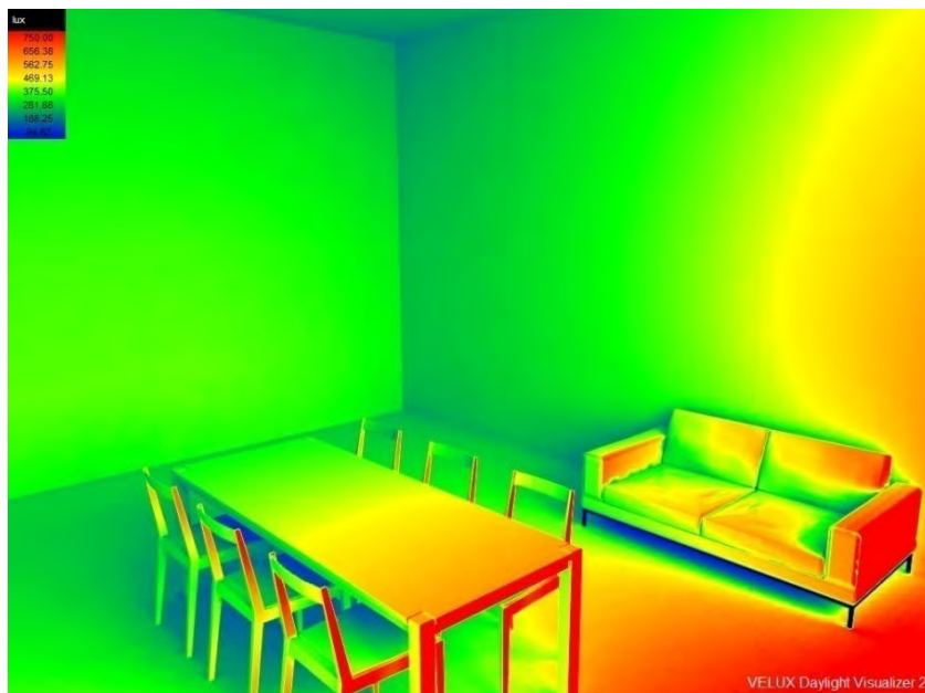
Vista prospettica dell'illuminamento medio calcolato il 21 marzo ore 12 in condizioni di cielo coperto.
