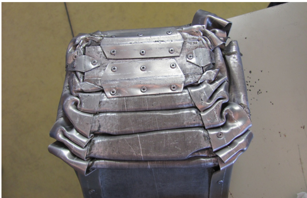
Figura 8.10: Vista dall'alto dell'assorbitore compresso
