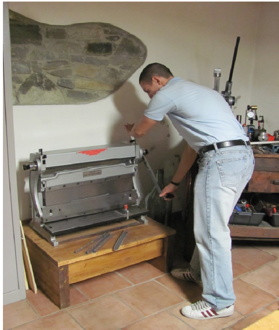
Figura 7.17: Piegatura delle strisce di lamiera
