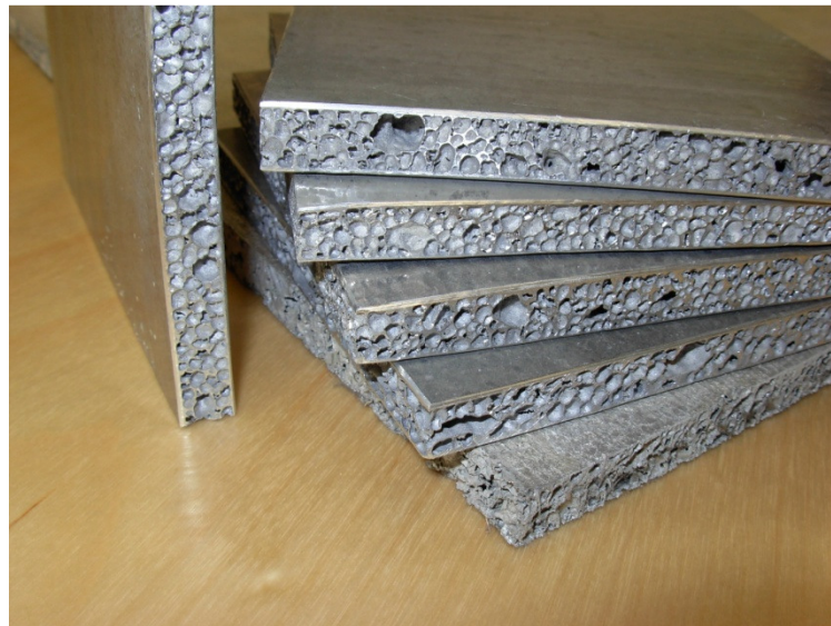
Figura 2.5: Pannelli sandwich con cuore in schiuma di alluminio
