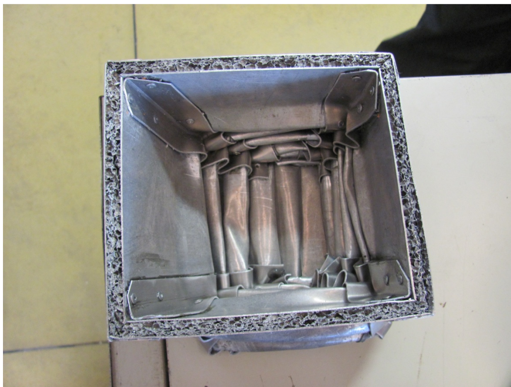
Figura 8.8: Vista da sotto dell'assorbitore compresso
