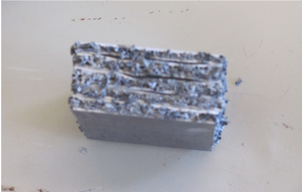
Figura 5.22: Provino dopo la prova di compressione
