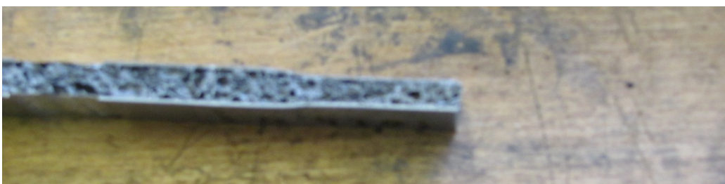
Figura 5.12: Schiacciamento locale del secondo provino
