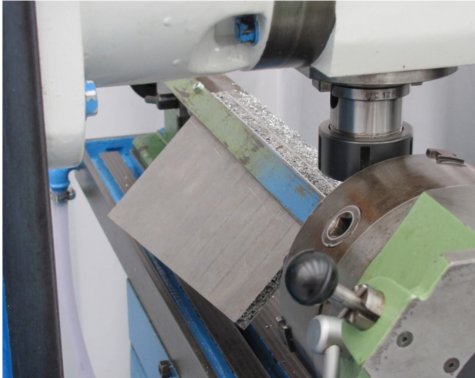
Figura 7.3: Attrezzatura per realizzare smussi
