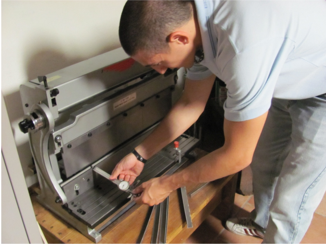
Figura 7.16: Misura della posizione del ferma-lamiera
