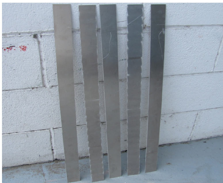
Figura 7.14: Alcune delle strisce di lamiera ottenute dopo taglio AWJ
