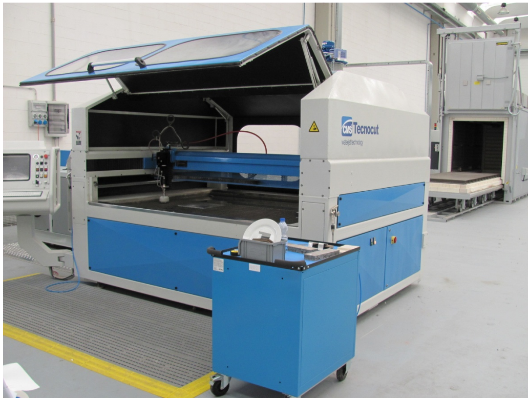
Figura 5.3: Attrezzatura per taglio AWJ
