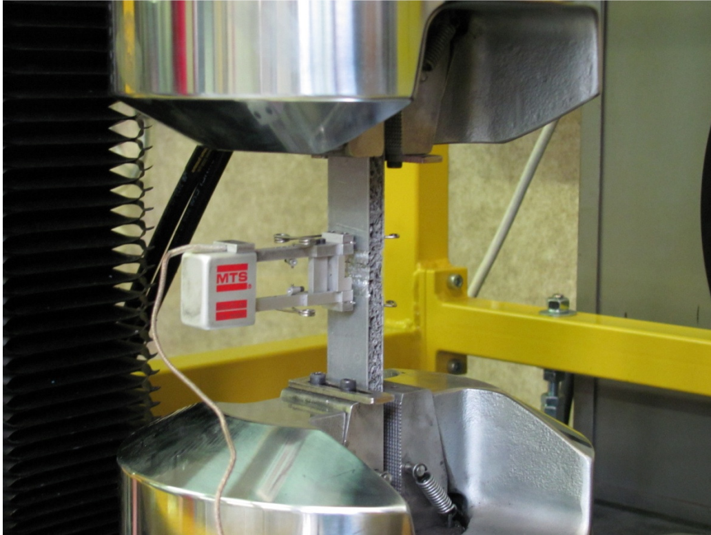
Figura 5.9: Provino pronto per la prova di trazione; si nota l'estensimetro MTS
