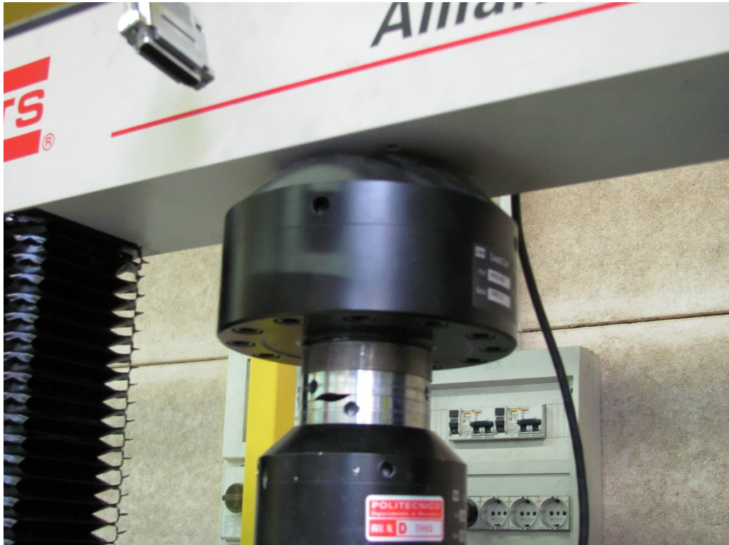
Figura 5.10: Cella di carico utilizzata per la prova di trazione
