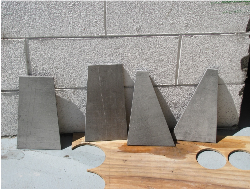
Figura 7.2: Pannelli sandwich con cuore in schiuma AlMgSi tagliati tramite AWJ
