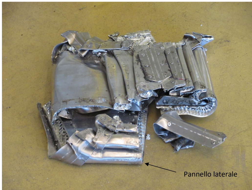
Figura 8.4: Assorbitore con cuore in honeycomb dopo l'urto; il pannello laterale non ha retto
