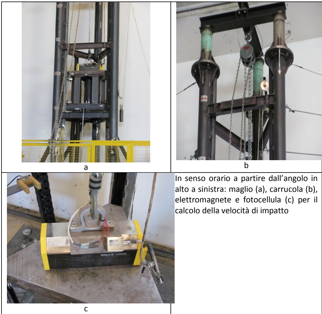
Figura 8.2: Alcuni particolari della torre di caduta
