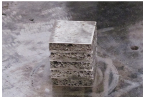
Figura 5.20: Provino pronto per la prova su torre di caduta
