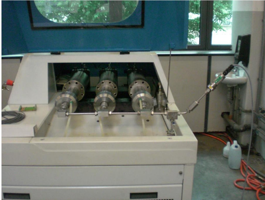
Figura 6. 3 Posizionamento del sensore di alta pressione sul ramo si uscita dell'intensificatore
