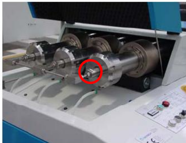
Figura 3. 21 Posizionamento della valvola di alta pressione
