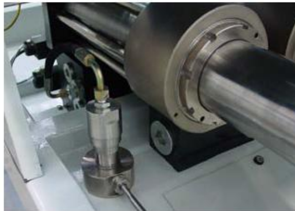
Figura 3. 31 Posizionamento valvola di alta pressione [Jet09]
