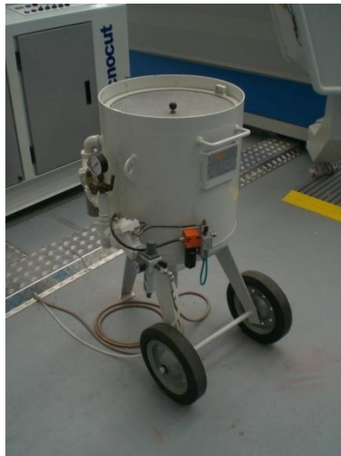
Figura 1. 1 Serbatoio di contenimento dell'abrasivo
