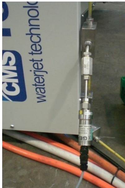
Figura 7. 26 Collegamento del sensore di pressione al condotto di alta pressione.
