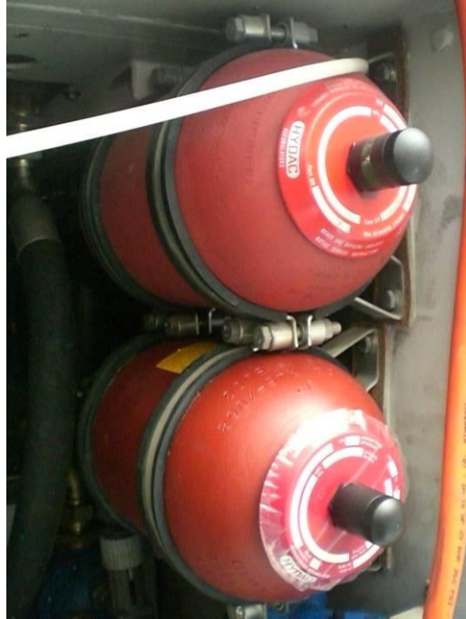
Figura 3. 13 Accumulatori su intensificatore a pompanti paralleli modello a 6 cilindri.
