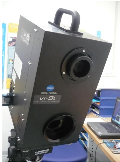
Figura 4.4: Lo scanner a triangolazione del laboratorio HAPRE
