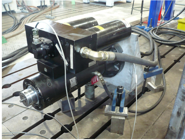
Figura 2.6: Attuatore idraulico utilizzato per la prova statica
