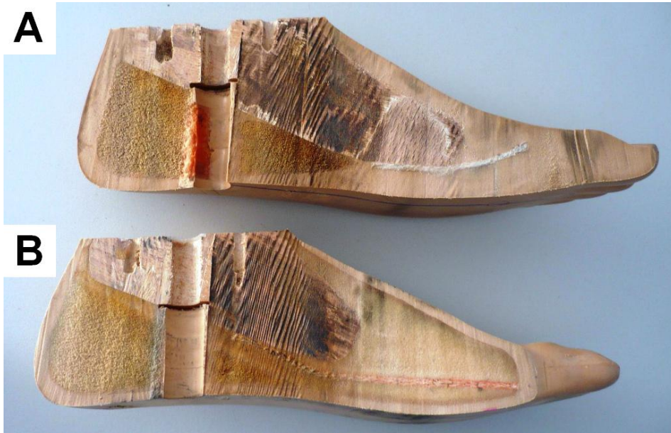
Figura 3.4: Sezione dei piedi A) SACH e B) Dynamic
