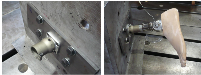
Figura 2.10: Dettaglio dell'attacco del piede protesico e piede vincolato alla piastra di contrasto
