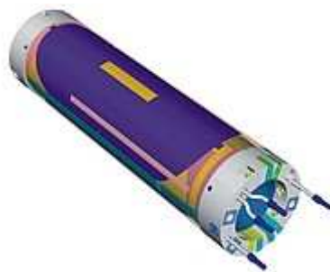
Figura 42. Sistemi di gradienti e shim integrati ad alte prestazioni.
