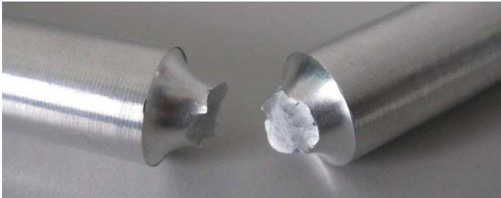
Figura 2.5: Provino round notched R = 5 mm dopo la prova di trazione
