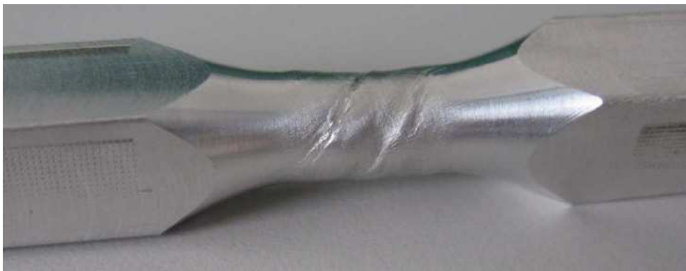
Figura 2.6: Provino dopo una prova multiassiale torsione-compressione
