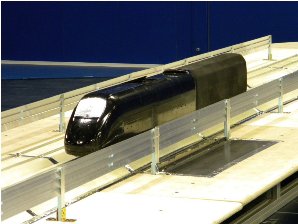
Figura 0.2 - ETR500, Double Track Ballast & Rail, prova in camera a strato limite della galleria del vento.
