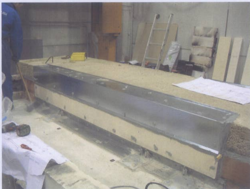
Fotografia della superficie non esposta al fuoco del campione durante la fase di allestimento.
