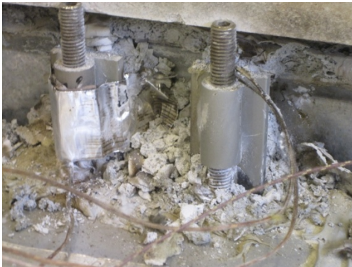
Figura IV-36 Staffe di fissaggio ancora integre a fine prova
