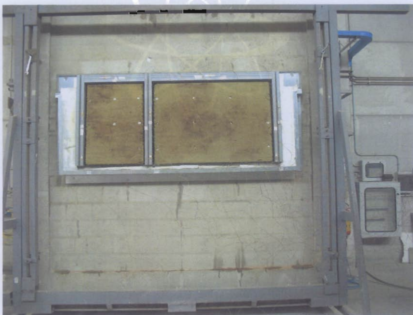
Fotografia della faccia non esposta al fuoco del campione dopo la prova.
