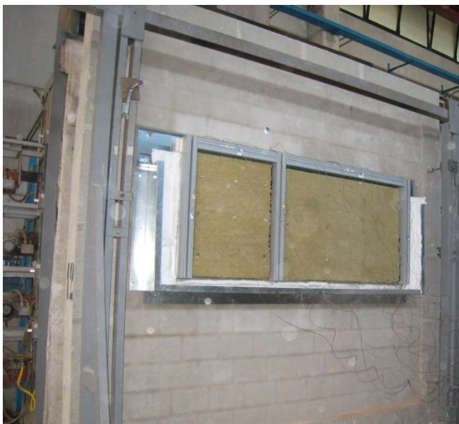
Figura IV-10 Lato esterno del forno
