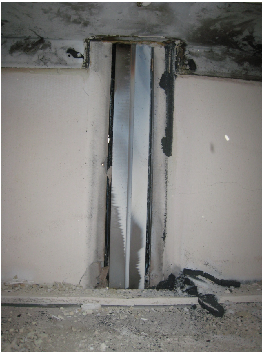
Figura IV-17 Termine della prova, montante integro
