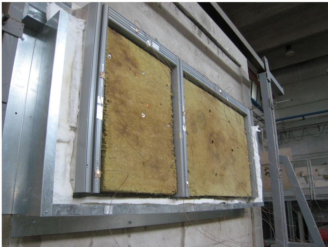
Figura IV-15 Prova in corso, isolante esterno annerito
