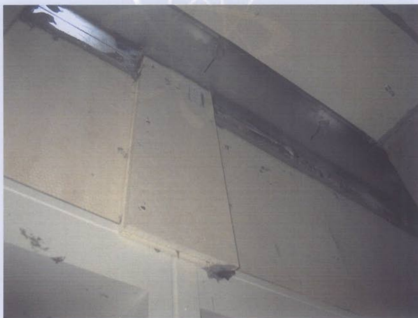
Fotografia del campione prima della prova visto dall'interno del forno sperimentale.
