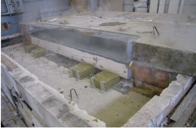
Figura IV-34 Assenza di fratture o fiamme sul lato non esposto
