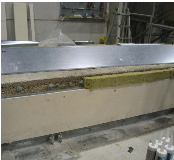
Figura IV-27 Isolamento della faccia non esposta
