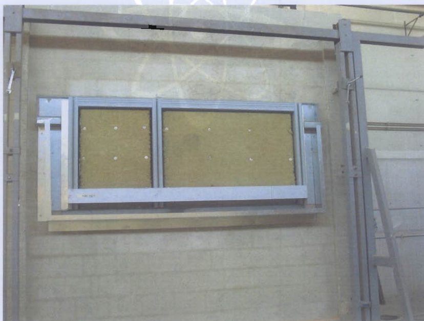
Fotografia della faccia non esposta al fuoco del campione prima della prova.
