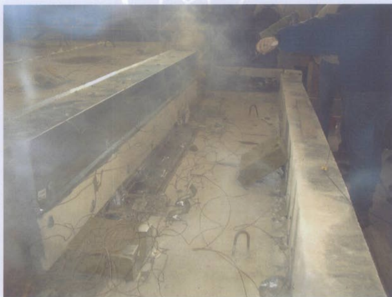
Fotografia della superficie non esposta al fuoco del campione durante una delle verifiche di tenuta eseguite dopo il 120° minuto di prova quando sono state rimosse le protezioni in lana di roccia dalle due staffe centrali.
