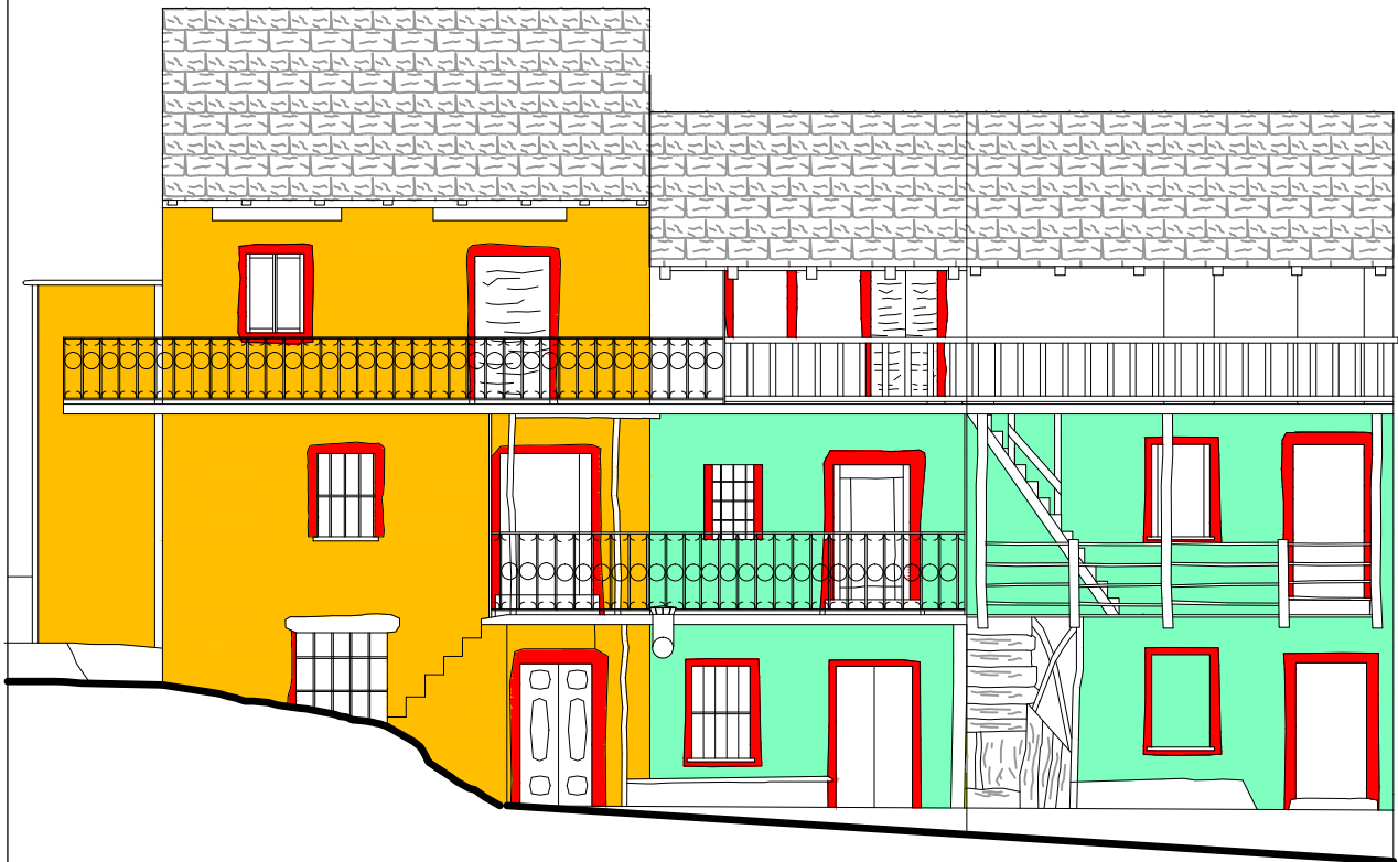
Scheda n°138: analisi del degrado del prospetto Nord degli edifici 92-93-94
