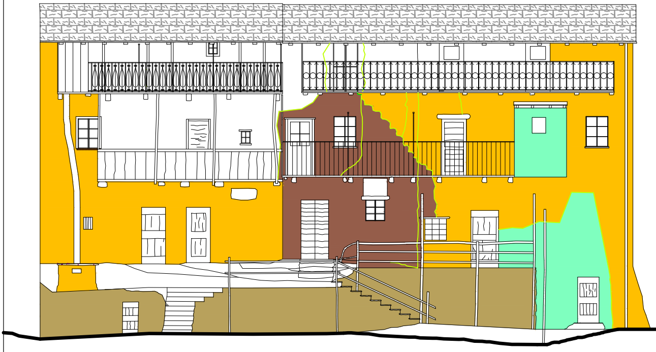
Scheda n°129: analisi del degrado del prospetto Nord degli edifici 98-99-100
