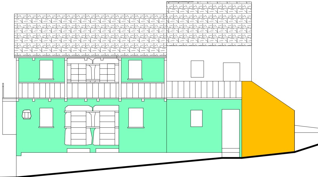
Scheda n°134: analisi del degrado del prospetto Nord degli edifici 95-96-97
