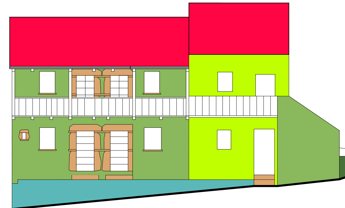
Scheda n°98: rilievo materico del prospetto Nord degli edifici 95-96-97
