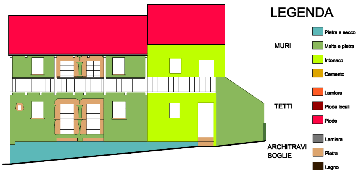
Figura n°205: Rilievo materico del prospetto Nord degli edifici
