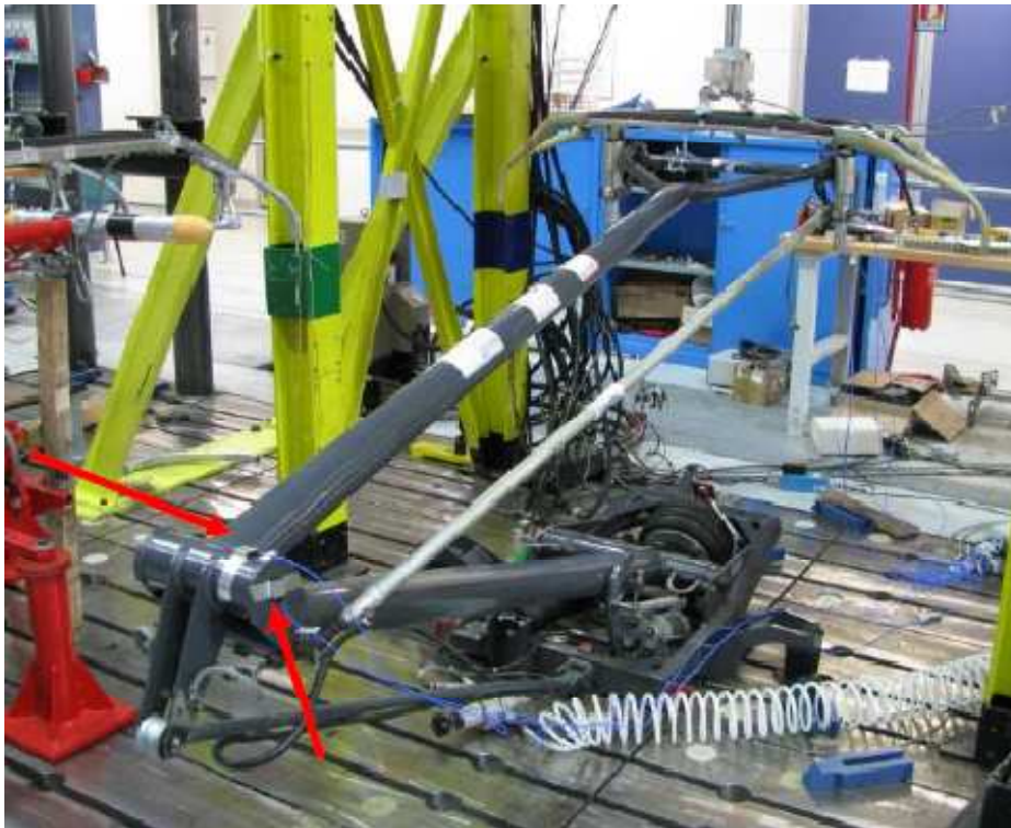
Figura 2.5: Posizionamento degli accelerometri sul naso del CX
