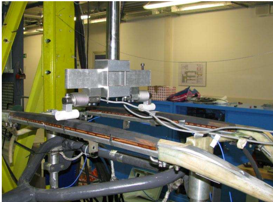
Figura 2.3: Posizionamento delle celle di carico
