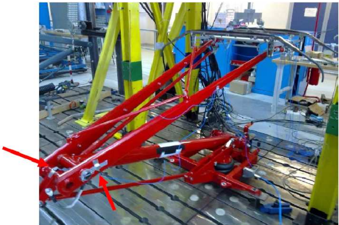
Figura 2.11: Posizionamento degli accelerometri sul naso del' Atr95
