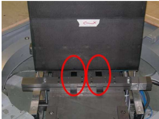
Figura 2.11: Modello aeroelastico della torre Isozaki: dettaglio degli elementi elastici
