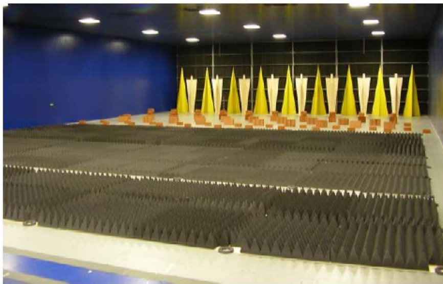
Figura 2.7: Elementi rugosi e spires per generare il profilo turbolento richiesto in camera di prova
