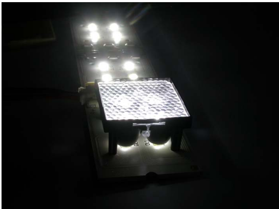
Fig. 6.16 Particolare della scheda LED con ottica MEDIUM BEAM da 25° accesa
