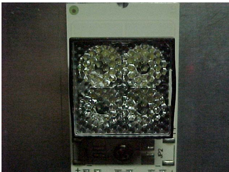
Fig. 6.22 Lente MEDIUM BEAM 25° sul goniometro
