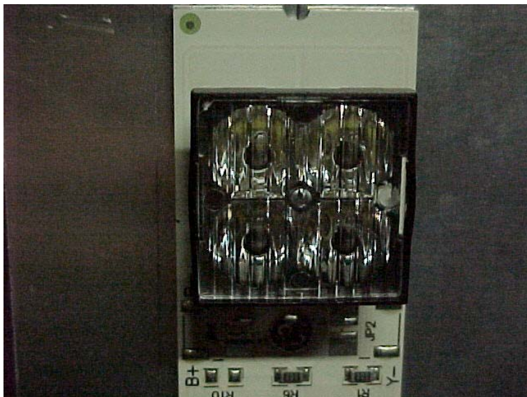
Fig. 6.24 Lente OVAL BEAM 15°/45° sul goniofotometro
