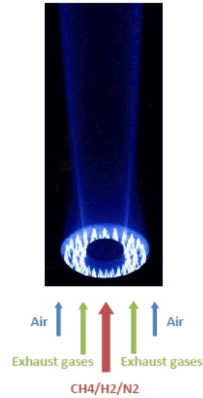
Figura 6.7: Fotografia della fiamma Sandia Piloted CH 4 /Air [47]
