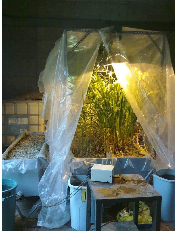
Figura 3.3: Fotografia dell'impianto pilota di fitodepurazione (aprile 2010).
