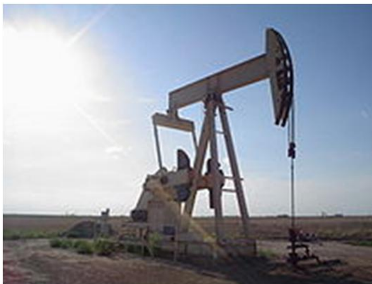
Figura 1.2: Pompa superficiale per l'estrazione del petrolio, a destra nella foto è visibile la testa pozzo (fonte: www.wikipedia.it ).
