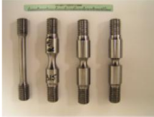
Figura 2.6: Foto di provini necessari per i test di calibrazione del criterio di frattura Johnson-Cook (immagine tratta da [33]).
