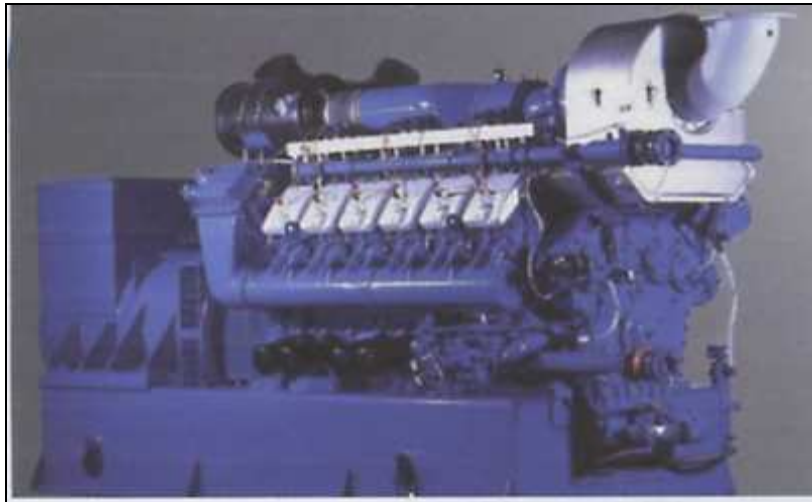
fig.10 – Motore a gas Deutz per cogenerazione da 300 kW e
