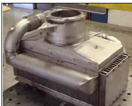
Fig. 21 – Rigeneratore di superficie primaria a forma di cubo
