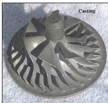
fig. 13 – Girante di compressore centrifugo in lega di titanio e silicio della TELEDYNE
