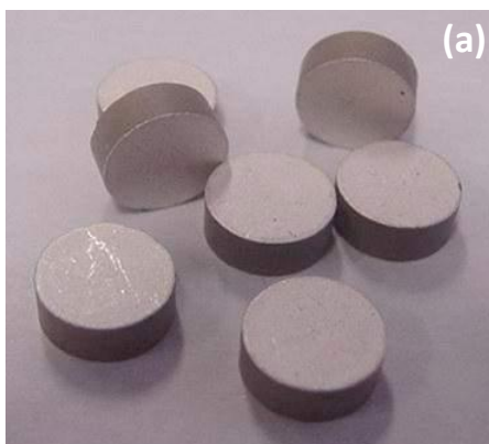
Fig.1.3: pastiglie PTC (a) con le relative proprietà (b).
