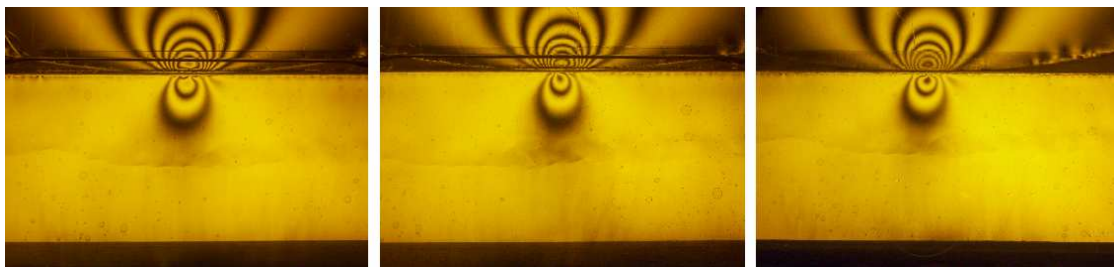
Figura 3.13) F=530,5N , l=300mm , h=65mm , a=7Mpa , policarbonato.
