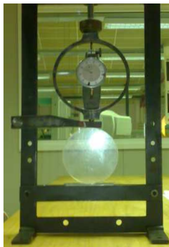
Figura 4.6) Sistema di carico della prova di taratura.
