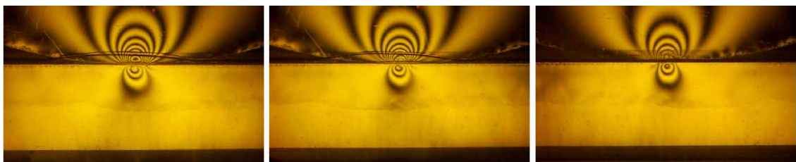
Figura 3.14) F=530,5\text{N} , l=300\text{mm} , h=65\text{mm} , a=7\text{Mpa} , v=0,1 \text{ m/s} , policarbonato.
