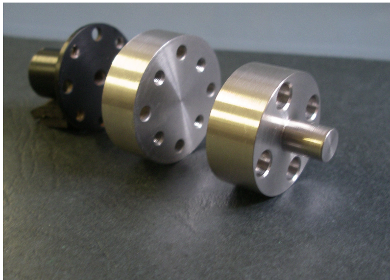
Figura 2.15 : Sequenza d'accoppiamento dei componenti per l'afferraggio superiore per la prova di compressione non confinata.
