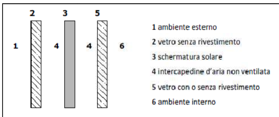
Figura 1. Schematizzazione della schermatura solare integrata con intercapedine non ventilata
