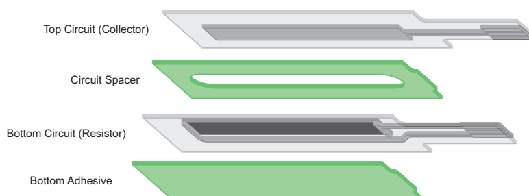
Figura 2.7.: Struttura striscia potenziometrica per misura passo pala
