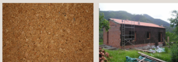
Panelli isolanti in sughero _panello e cantiere
