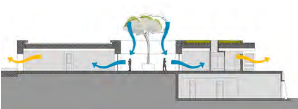
Fig. 103 – Funzionamento del cortile ai fini della ventilazione
