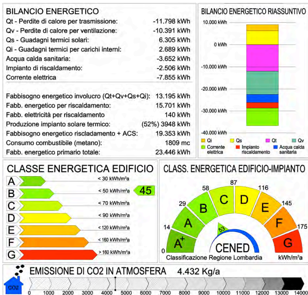
Figura 402 - Bifamiliare 3: quadro riassuntivo - archivio personale
