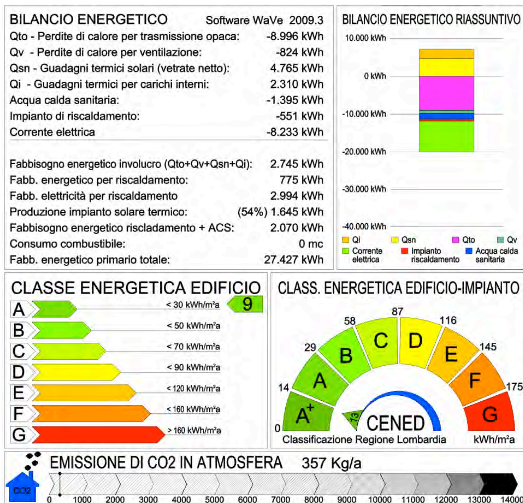
Figura 413 - Bifamiliare 5: quadro riassuntivo - archivio personale
