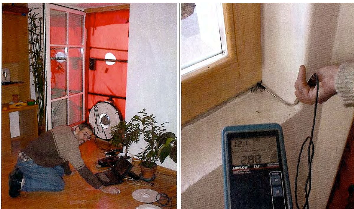
Figura 196 - Blower Door test - fonte TBZ
