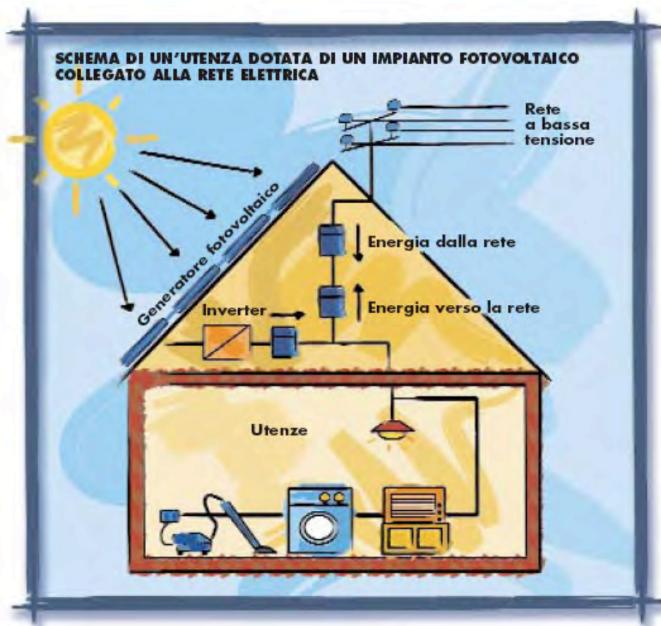
Figura 85 – Schema di impianto grid-connected - fonte Enea
