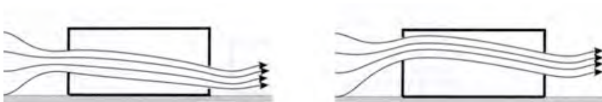
Figura 65 - Ventilazione passante orizzontale - fonte mybestlife
