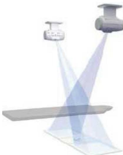
**Figura 2.3: sistema di detettori e sorgenti di raggi X [8].**
