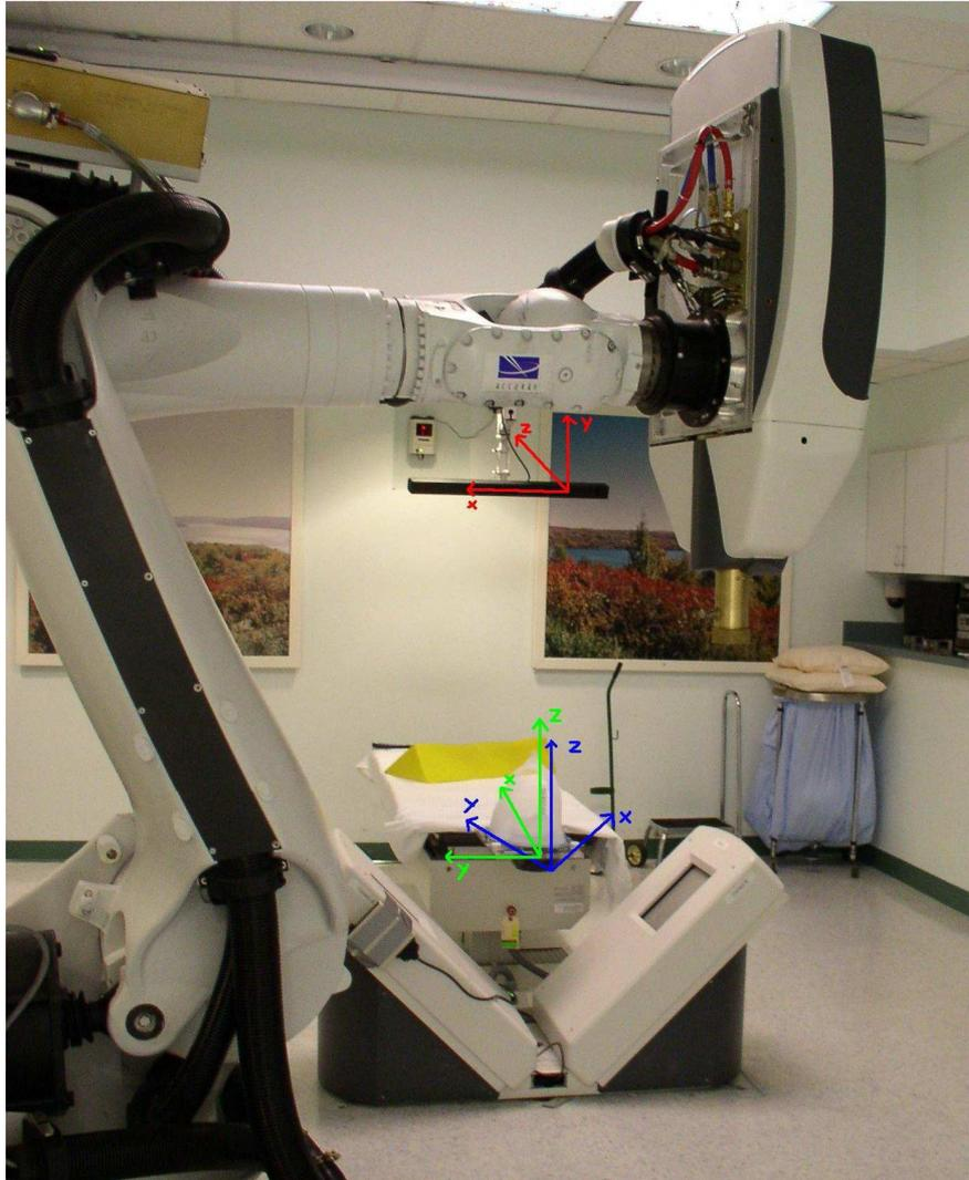
Figura 2.6: il sistema di riferimento identificato dalle direzioni anatomiche del paziente è indicato in verde, quello del sistema di imaging in blu ed in rosso quello utilizzato dal sistema optoelettronico [8].
