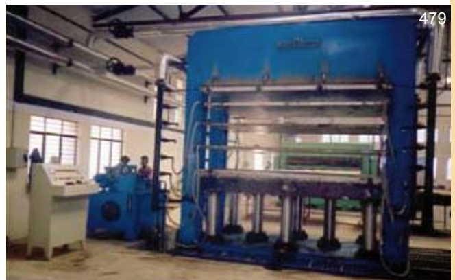
foto 479: macchina con pressa da 850 tonnellate per la compressione a caldo del materassino impregnato
