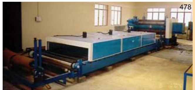
foto 478: macchina per l'impregnazione con resine (fenoliche o naturali) del materassino di fibre
