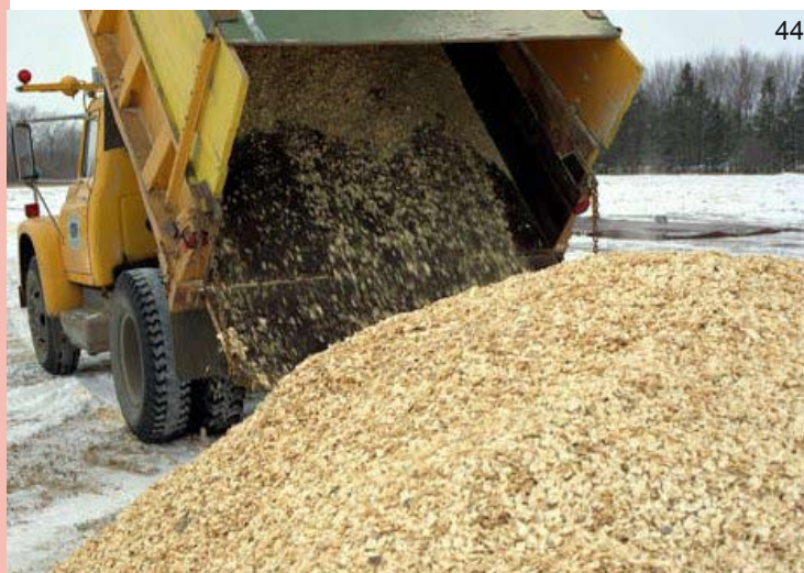
foto 44-45: gli scarti della lavorazione dell'industria del legno possono essere riutilizzati per ottenere isolanti termoacustici naturali. Gli scarti vengono ridotti in pezzi di uguale misura, e lavorati con un procedimento che utilizza esclusivamente vapore acqueo per la sfibratura e, come collante, la resina naturale del legno. Si ottiene così una pasta di fibra di legno che poi, tramite un processo di disidratazione ed essiccazione a 180° C, si trasforma nel prodotto finale: i pannelli isolanti in fibre di legno.
