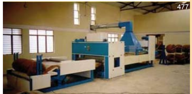
foto 477: macchina per il compattamento delle fibre in un materassino
