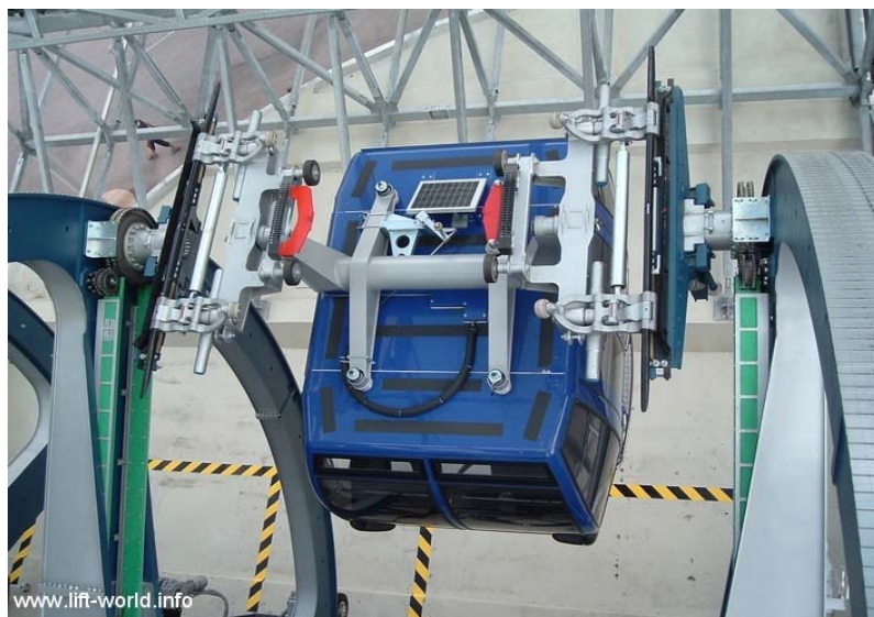
F126. Cabina in transito sulle grandi ruote. Da notare il sistema di aggancio, con il carrello soltanto "appoggiato" su dei sostegni orizzontali
