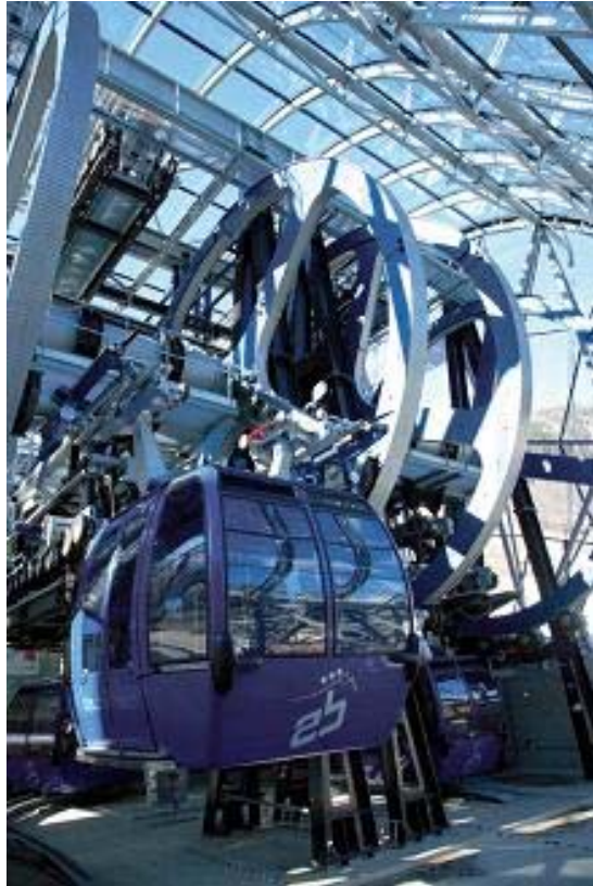
F122. Discesa della cabina al piano di imbarco/ sbarco mediante le "grandi ruote"
