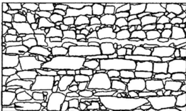
Rilievo di paramento murario in cui si nota la presenza di "corsi" talvolta costituiti da un unico filare di pietre, talvolta costituiti da pietre di altezze diverse in cui alle pietre più piccole si sovrappongono uno o più elementi per ottenere il pareggiamento.
