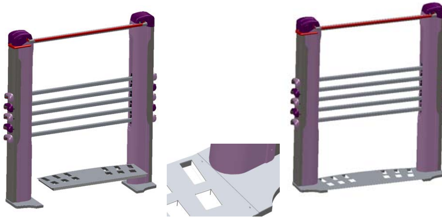
Figura 31_ Sequenza di fissaggio della pedana fissa
