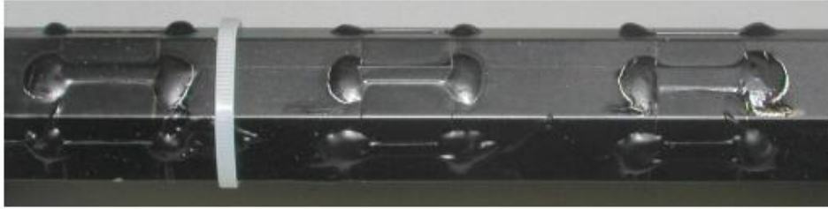
Figura 2.4: Particolare sull'incollaggio degli estensimetri in metallo.
