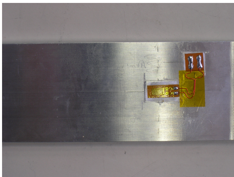
Figura 5.4: Provino in alluminio utilizzato per le prove di trazione: particolare sull'installazione dei cavi di rame tra estensimetro e basetta di collegamento.
