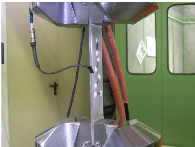
Figura 7.3: Posizionamento degli estensimetri infrarossi sul provino in alluminio.
