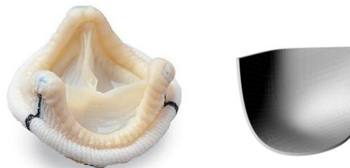
Figura 5.1 Foglietto reale a confronto con un foglietto generato da Rhinoceros utilizzando lo script.
