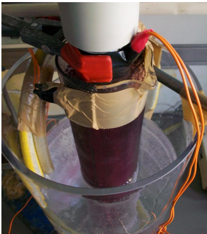
Figura 6.20 – Reattore di fotodegradazione. Si possono osservare i contatti elettrici deputati alla polarizzazione del catalizzatore (rossi) e del catodo in DSC (neri). I tubi in materiale plastico sono utilizzati per il ricircolo dell'acqua di rete nel cilindro esterno necessario al raffreddamento del reattore.
