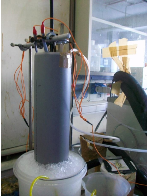
Figura 6.4 – Reattore di ossidazione anodica. Configurazione per soluzioni di \text{H}_2\text{SO}_4 1M + HF 0,15%. Si possono osservare gli elementi caratteristici del sistema di raffreddamento: il tubo per il gorgogliamento dell'azoto raffreddato e il cilindro esterno di raffreddamento con ghiaccio.
