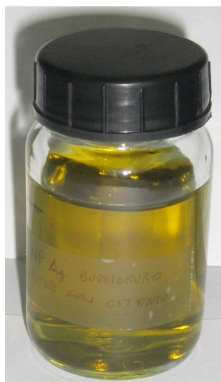
Figura 18. Nanoparticelle di argento ottenute mediante riduzione con boroidruro di sodio e stabilizzate con citrato. La colorazione limpida della soluzione è dovuta alla presenza di nanoparticelle dal diametro molto piccolo (~10 nm). Con questo metodo di sintesi, se non si aggiunge il citrato, lo strato interno del doppio strato elettrico è principalmente costituito dagli ioni BH_4^- e HBO_3^- che si legano meno fortemente all'argento rispetto al citrato [Creighton (1979)], diminuendo in questo modo la stabilità del colloide nel tempo.
