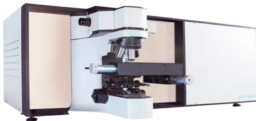
Figura 1. Raman dispersivo LabRAM HR800 in modalità micro con microscopio Olympus BX41 e stage per misure di mapping.
