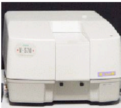
Figura 6. Spettrometro UV-VIS della JASCO V-570: tale spettrometro fornito di lampada alogena come sorgente permette di coprire anche il range del NIR.
