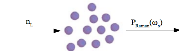
Figura 14. Le N molecole di analita attraverso la loro sezione d'urto permettono di fornire in uscita un segnale Raman (\omega_s) alle frequenze Stokes caratteristiche.
